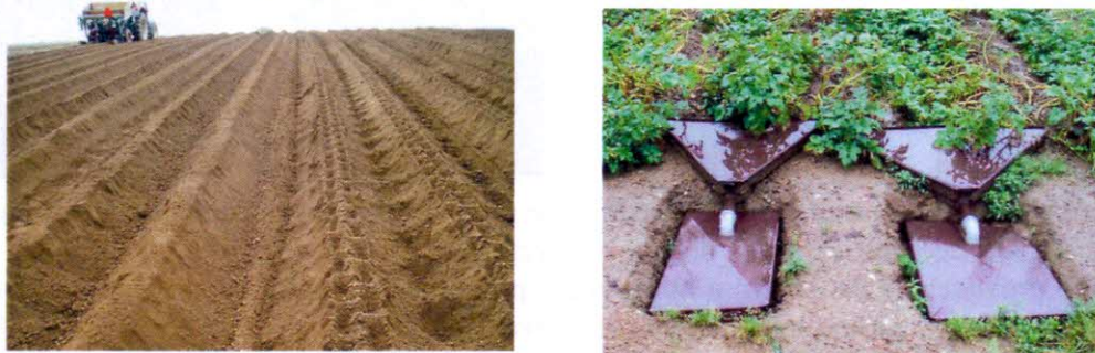
Obr. 1: Založení pokusu sazečem s důlkovacím adaptérem a měření smyvu odděleně z nekolejové a širší kolejové brázdy
