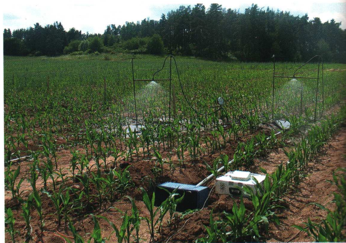
Obr. 1: Měření povrchového odtoku simulátorem deště v porostu kukuřice
