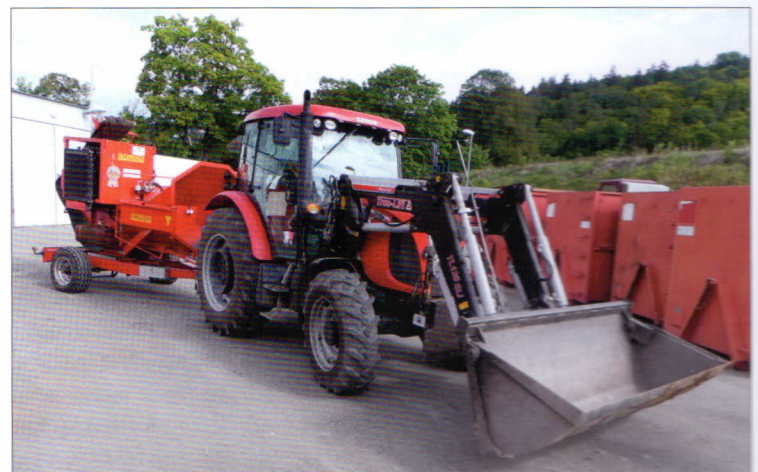
Manipulace se surovinami – adaptér k traktoru – čelní nakladač Trac-Lift TL120SLi, objem lopaty 0,6 m 3
