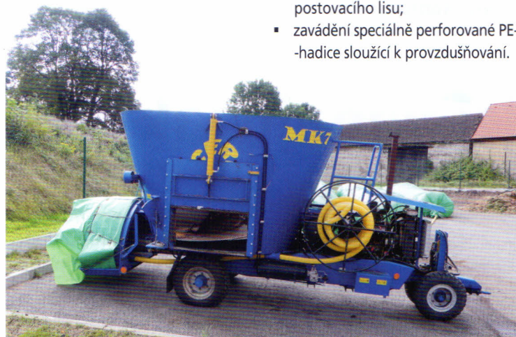
Promíchávání a homogenizace surovin, plnění kompostovacích vaků – mobilní kompostárna CERNIN MK 7, objem pracovního prostoru 7 m 3 , výkonnost 42 m 3 /h, počet šneků – 1, vybavení – hydraulická ruka, pás
