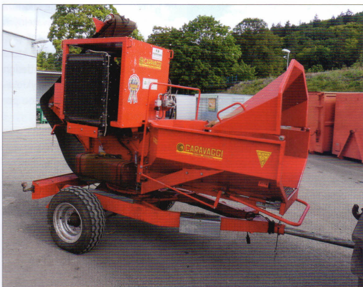
Jemná dezintegrace – drtič CARAVAGGI BIO 600 s dieselovým motorem 59 kW, max. průměr dřevní hmoty 180 mm. Je vybaven drticím bubnem s 64 kladívky, teoretická výkonnost – 20 m 3 /h
