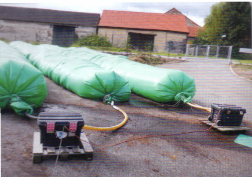
Systém pro provzdušňování – ventilátor s řídicí jednotkou zajišťuje regulované provzdušňování, provzdušňovací hadice z materiálu PE s průměrem 90 mm a délkou 60 m (hadice se používá opakovaně), vestavěné ventilační průduchy z materiálu PE jsou opakovaně použitelné
