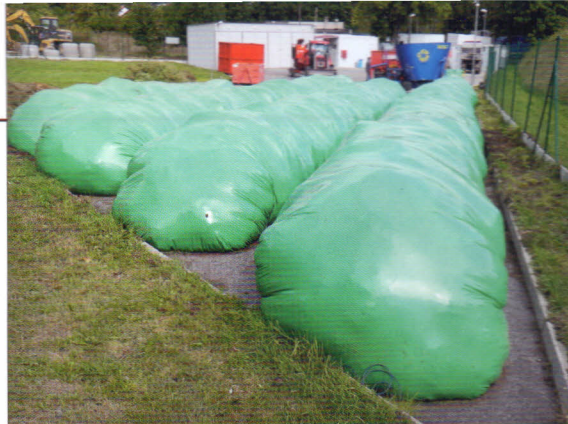
Kompostovací proces – kompostovací vaky z materiálu LDPE, rozměry – délka max. 60 m, průměr 1,5 m, úložná kapacita jednoho vaku zhruba 80 t (Ø1,5 x 60,0 m). Vak je určen k jednomu naplnění, fólie vaku je recyklovatelná
