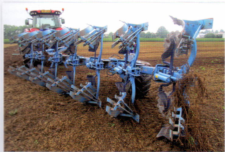
Návěsný sedmiradliční oboustranný pluh Farnet Vidium P 350 Vario s prutovou odhrnovačkou Foto Pavel Kovaříček
