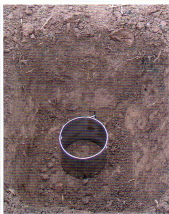
Měřicí válec zapuštěný 0,05 m pod povrch půdy před měřením v hloubce 0,30 m Foto Marcela Vlášková
