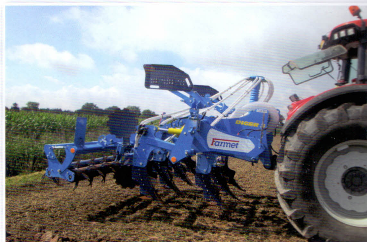
Hloubkový kypřič Digger 3, osazení dvěma řadami dlát s křídly, řadou rovnacích talířů a dvojítm hrotovým válcem pro drobení hroud
