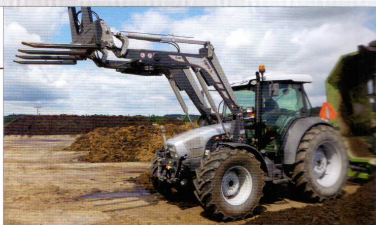
Energetický prostředek – kolový traktor LAMBORGHINI R3 EVO 100 (72,5 kW) s čelním nakladačem Sigma 4
