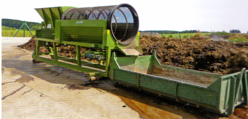
Prosévání kompostu – bubnový třídič PEZZOLATO typ L 3000 s dieselovým motorem Lombardini 38kW, výkonnost asi 30 m 3 /h (závisí na vlastnostech proséváných surovin)
