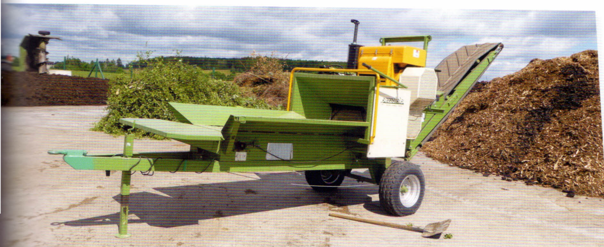
Jemná dezintegrace – drtič PEZZOLATO S 7000 (energetický zdroj – dieselový motor 40 kW, max. – dřevní hmoty 200 mm, teoretická výkonnost 20 m 3 /h)
