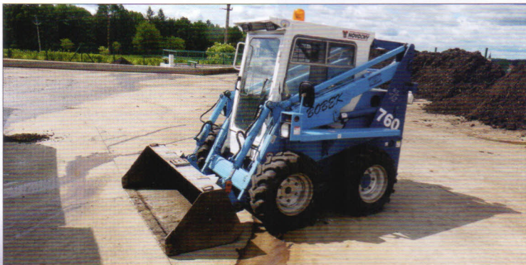
Manipulace se surovinami – smykem řízený nakladač Novotný Bobek 760 (výkon motoru 45 kW, rychlost 18 km/h, objem lopaty 0,53 m 3 , výška zdvihu 2,60 m)
