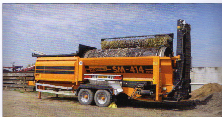
Prosévání vyrobeného kompostu – pronajatý rotační třídící Doppstadt SM 414 (diesellový motor 30 kW)
