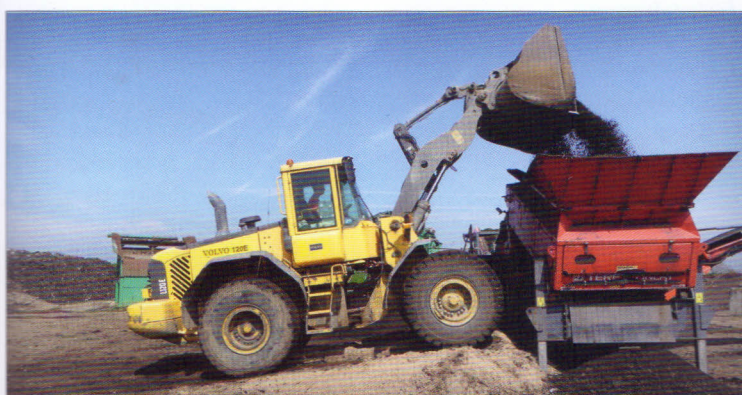
Manipulace se surovinami, překopávání kompostu – kolový nakladač VOLVO (motor s výkonem 87 kW, objem lopaty 1,8 m 3 )
