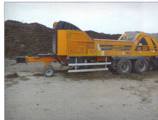
Jemná dezintegrace – rychloběžný drtič Doppstadt AK 235PS s dieselovým motorem (175 kW) a drtičím bubnem – 32 kladiv (2 řady po 16 kladivech). Dodrcovací síto s oky 20 x 20 cm (kompost) a 6 x 6 cm (štěpka)
