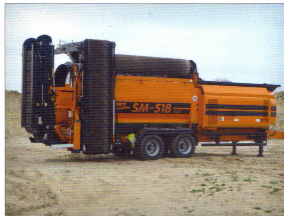
Prosévání kompostu – rotační třídič Doppstadt SM 518PLUSPS s dieselovým motorem 55 kW a bubnem s oky 20 x 20 mm
