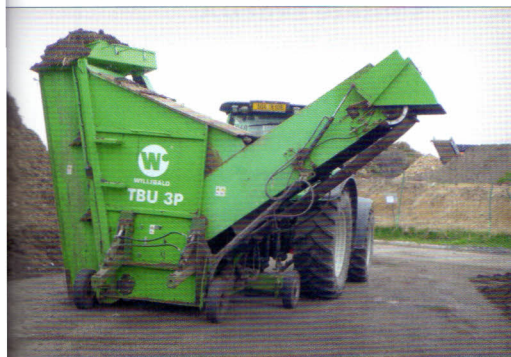
Překopávání kompostu – tažený překopávač kompostu WILLIBALD TBU 3P v agregaci s kolovým traktorem VALTRA N163 (výkon motoru 119 kW). Pracovní prostor překopávače je 4 x 3 m a výkonnost dosahuje 1200 m 3 /h
