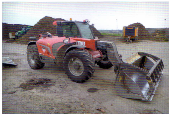
Manipulace se surovinami – teleskopický manipulátor MANITOU MLT 735-120LSU TURBO. Dieselový motor Perkins má výkon 91 kW. Hydrodynamický pohon 4 x 4, el. hydr. reverz, výška zdvihu 6,86 m. Vybavení – lopata s přídržovačem 2 m 3 a paletizační vidle
