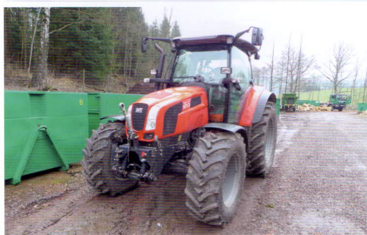
Energetický prostředek – kolový traktor SAME Virtus s výkonem motoru 92 kW. Převodovka pracuje s třístupňovým násobičem plazivé rychlosti
