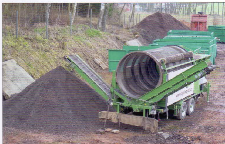
Prosévání kompostu – bubnový třídič PEZZOLATO typ L 3000 M poháněný dieselovým motorem Lombardini 38 kW. Násypka má objem 3 m 3 , velikost oka síta 20 x 20 mm, výkonnost 20–40 m 3 /h (závisí na vlastnostech proséváných surovin)
