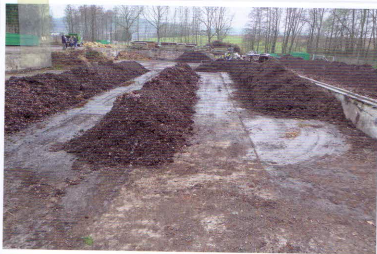
Kompostovací plocha je tvořena dnem plaveckého bazénu, je vodohospodářsky zabezpečena, celková výměra plochy 1000 m 2
