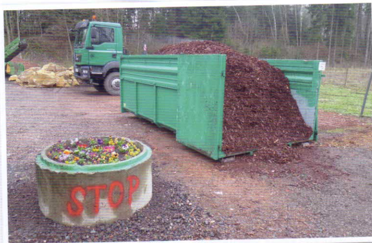
Kontejner se sklopnými bočnicemi o objemu 17 m 3
