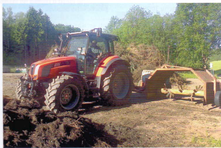
Překopávání kompostu – tažený překopávač kompostu PRT 2500 STS Třebíč – pracovní prostor 2,5 x 1,4 m. Výkonnost 300 m 3 /h závisí na vlastnostech překopávaných surovin
