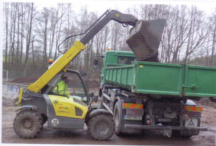
Manipulace se surovinami – manipulátor Kramer allrad 1245 s výkonem motoru 23 kW a výškou zdvihu 4 m. Maximální užitečné zatížení dosahuje 1200 kg. Pracuje s objemem lopaty 0,8 m 3
