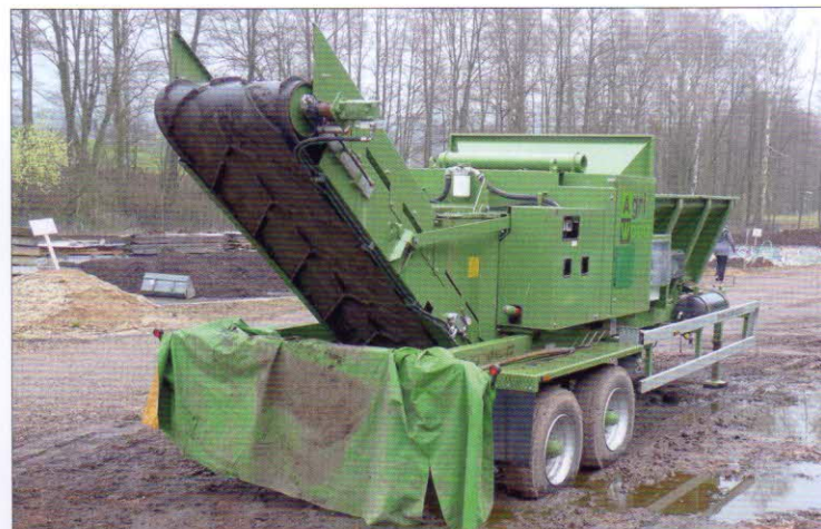
Jemná dezintegrace – drtič PEZZOLATO S 9000G zpracuje dřevní hmotu s maximálním průměrem 350 mm. Frakce jsou nastavitelné od 20 do 100 mm, teoretická výkonnost dosahuje 30–40 m 3 /h (závisí na vlastnostech překopávaných surovin)
