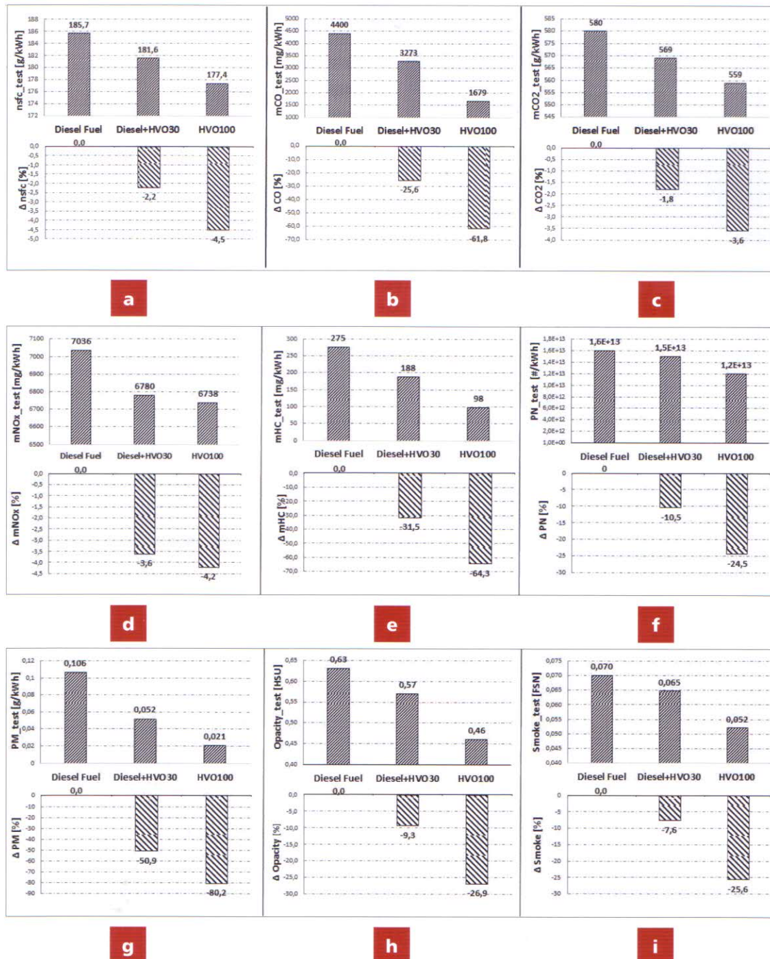
Obr. 4. – Výsledky WHSC testu: a) měrná spotřeba paliva, b) měrná produkce emisí mCO, c) měrná produkce emisí mCO 2 , d) měrná produkce emisí mNO x , e) měrná produkce mHC, f) měrný počet emitovaných pevných částic PN, g) měrná hmotová emise pevných částic, h) opacita, i) kouřivost
