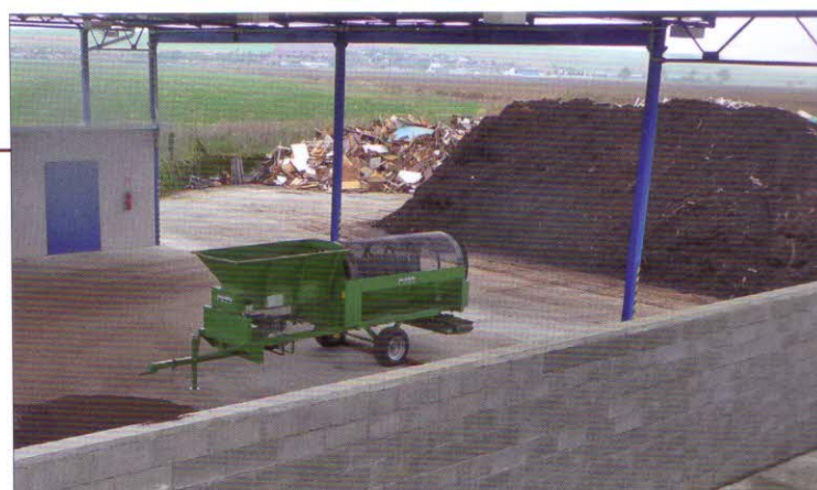
Obr. 13 – Bubnový třídič PEZZOLATO typ L 3000 M
