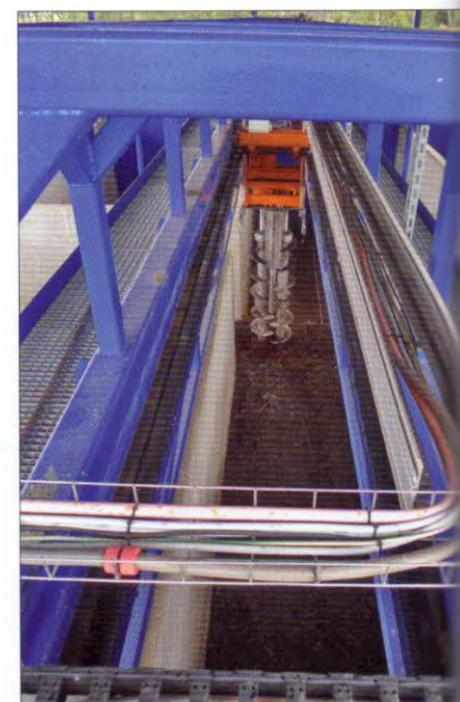
Obr. 11 – Dvourotorové promíchávací zařízení je vybavené dvěma šnekovicemi
