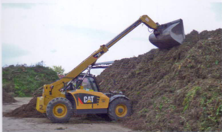
Obr. 8 – Tvorba zakládky kompostu teleskopickým manipulátorem CAT.H407
