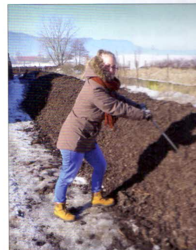
Monitorování kompostovacího procesu – teplotní sonda AGRETO; délka tyčové sondy 1,5 m; rozsah měření -50 až +110 °C s přesností ±1 °C
