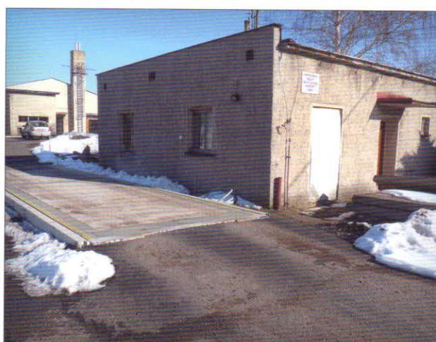
Evidenční přijímaných surovin – silniční mostní váha Tenzon 12 x 3/40 t s váživostí do 40 t a přesností ± 10 kg
