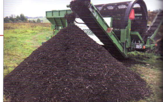
Prosévání kompostu – bubnový třídič PEZZOLATO typ L 3000 s dieselovým motorem Lombardini 38 kW. Násypka má objem 3 m 3 , velikost oka síta 25 x 25 mm, výkonnost zhruba 30 m 3 /h (závisí na vlastnostech prosévaných surovin)
