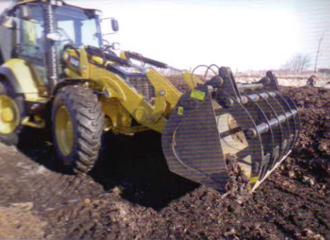
Manipulace s materiálem a tvorba zakládek – rýpadlonakladač CAT 444 F2 s dieselovým motorem 74 kW. K příslušenství patří velkoobjemová čelní lopata, čelní lopata s přidržovačem, zadní naklápači „svahovka“ na tvarování hromad v zakládkách
