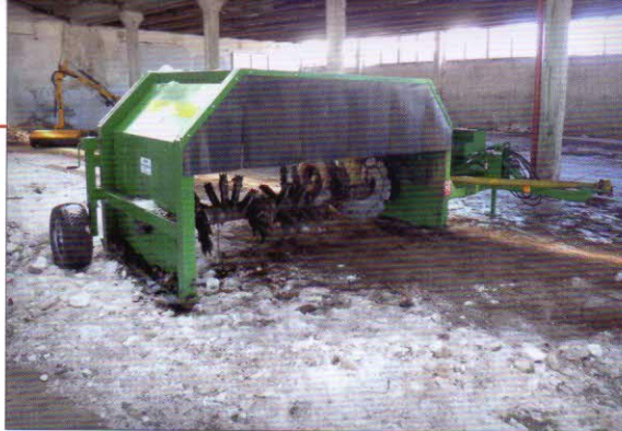
Překopávání kompostu – překopávač kompostu WASTE SERVICE TPK 300 v agregaci s traktorem CASE 230. Pracovní prostor je 3 x 1,6 m, výkonnost dosahuje 500 m 3 /h (závisí na vlastnostech překopávaných surovin)
