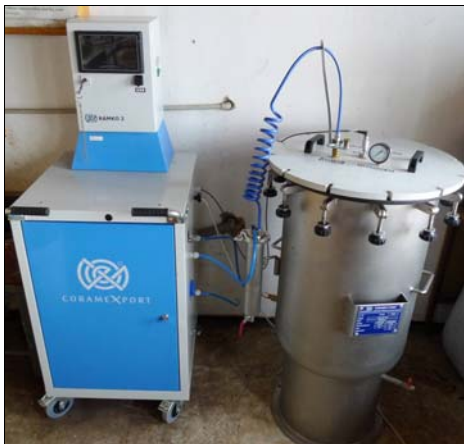
Obr. 2: Stanovování stability kompostu v laboratoři (Zdroj: P. Plíva)
