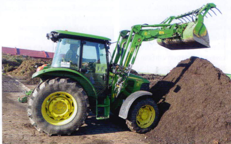
Energetický prostředek – kolový traktor John Deere 5090 M s výkonem motoru 68 kW
