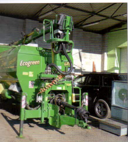
Promíchávání a homogenizace surovin – drtič biomasy ECOGREEN – Zago 7SD GRU (objem násypky – 7 m 3 )
