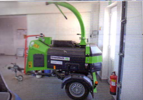
Drcení surovin – stroj GreenMech QC0160TT s dieslovým motorem o výkonu 27 kW zpracuje dřevo o průměru 150 mm (výkonost asi 7 t/h dle fyzikálních vlastností zpracovávaných surovin)
