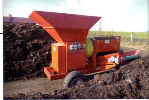
Proseávání kompostu – bubnová prosevačka substrátu NOVER BPS-02 (energetický zdroj – elektromotor 2,95 kW, velikost oka síta 20 x 20 mm a výkonost 15–25 m 3 /h (podle fyzikálních vlastností zpracovávaných surovin))
