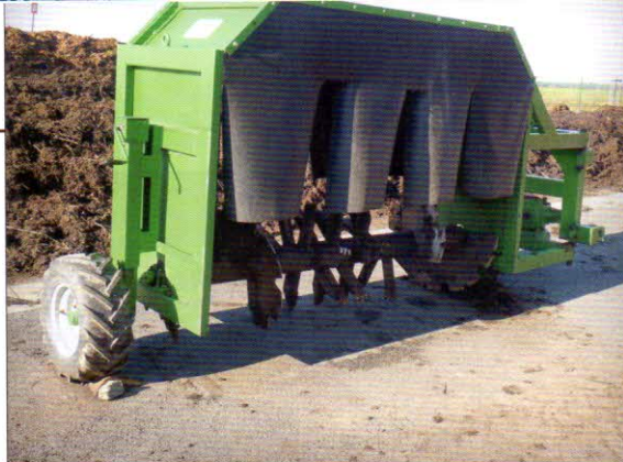
Překopávání kompostu – tažený překopávač kompostu EPK 225, pracovní prostor 2,25 x 1,6 m, výkonost 700–750 m 3 /h
