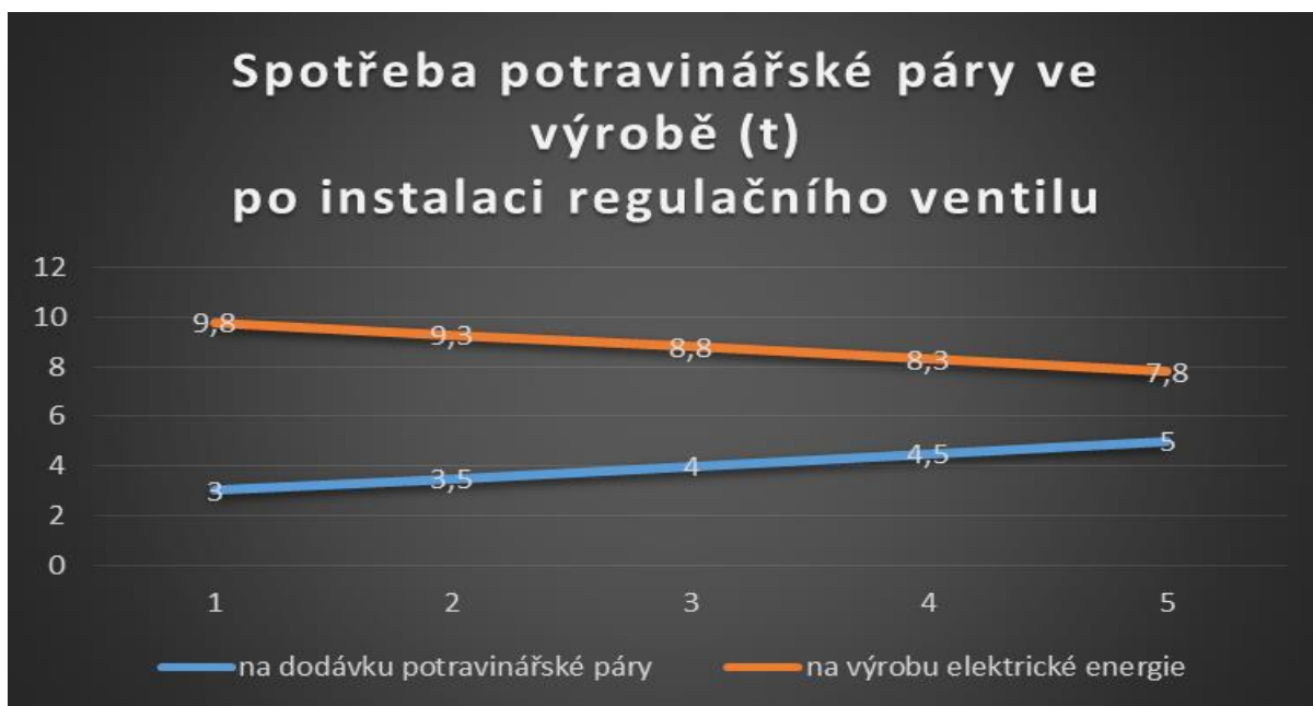
Graf č. 3: Spotřeba potravinářské páry ve výrobě po instalaci zkušebního regulačního ventilu
