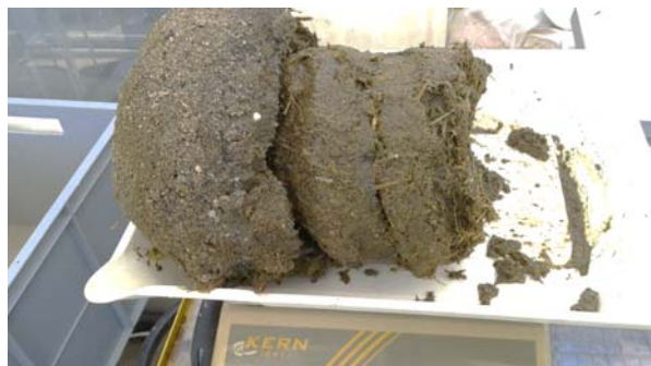
Obr. 3: Těsnící koláč vytvořený částicemi kejdy s 3% sušiny, v oblasti vstupu kejdy do písčitého substrátu během experimentu (rozhraní mezi komorou 6 a 7)
