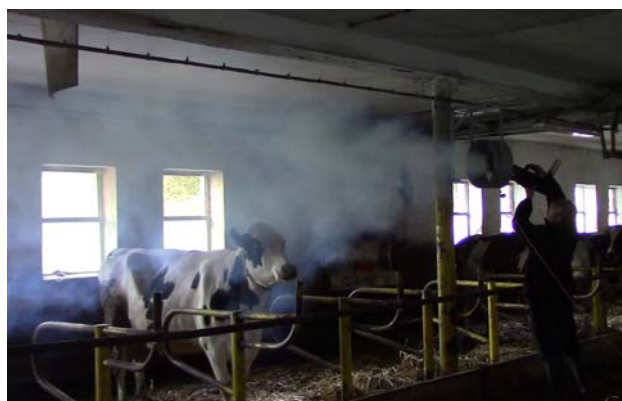
Obr. 2 Průběh kouřové zkoušky po nainstalování ventilátorů
