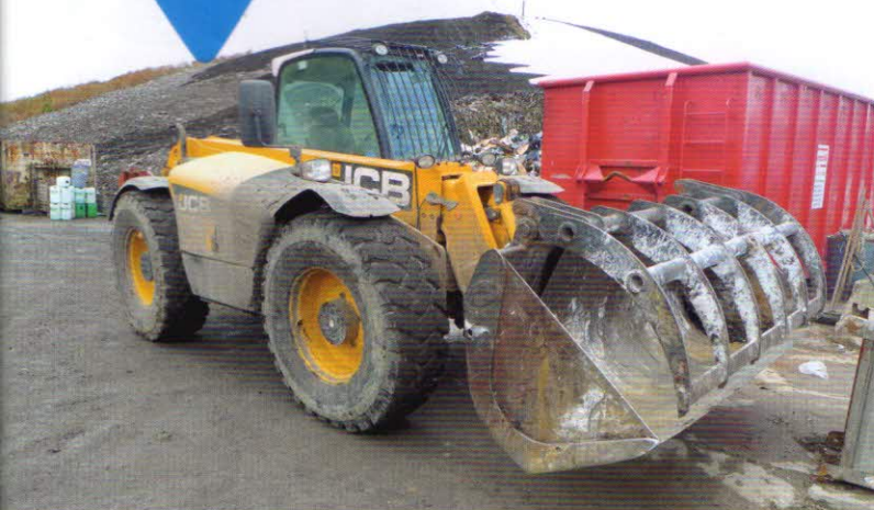
Manipulace se surovinami – teleskopický manipulátor JCB 541-70 agri s dieselovým motorem JCB ECOMAX (81 kW), výškou zdvihu sedm metrů a nakládací lopatou (1,3 m 3 )
