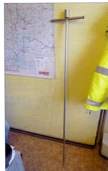
Monitorování kompostovacího procesu – zapichovací tyčový teploměr SUMMIT Co typ SDT9 s elektronickým systémem měření a ručním odečtem a zápisem. Měří v rozsahu –40 až +150 °C
