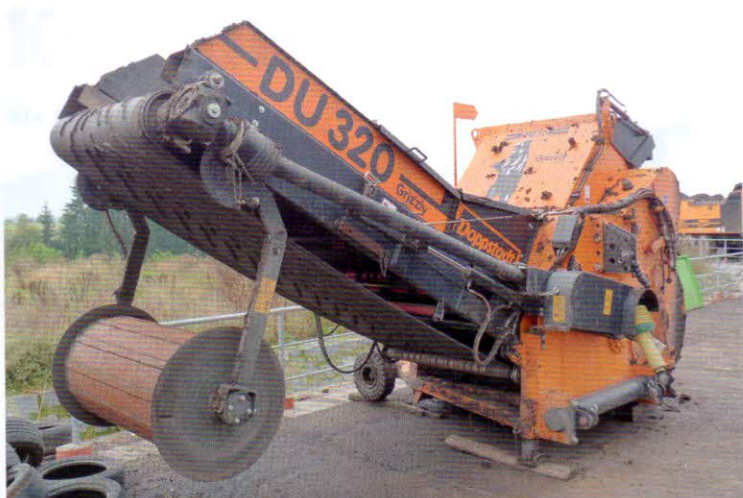
Překopávání kompostu – tažený překopávač kompostu Doppstadt DU 320 – Grizzly v agregaci s kolovým traktorem Fendt. Pracovní prostor 5 x 3 m a výkonnost 300–500 m 3 /h (dle fyzikálních vlastností zpracovávaných surovin)
