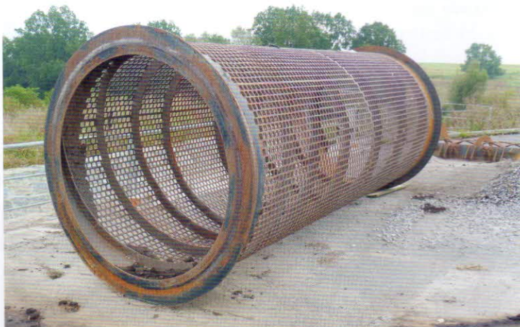
Prosévání kompostu – bubnový třídič Doppstadt SM 518PS s násypkou 3 m 3 a bubnem s oky 20 x 20 mm
