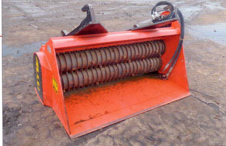
Homogenizace a promíchávání surovin – lopata IDEACHIP Oy ALLU SML 2-17 potřebuje energetický zdroj s minimálním výkonem 37 kW (teleskopický manipulátor JCB). Výkonnost 3–6 m 3 /h (dle fyzikálních vlastností zpracovávaných surovin)
