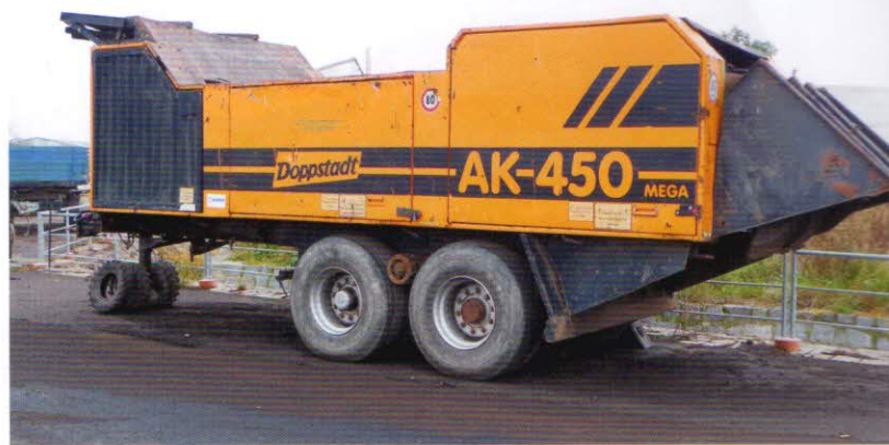
Jemná dezintegrace – rychloběžný drtič Doppstadt AK 450PS s dieselovým motorem (330 kW) a výkonností zhruba 50 m 3 /h (podle fyzikálních vlastností zpracovávaných surovin a logistiky ukládání zpracovávaných surovin)
