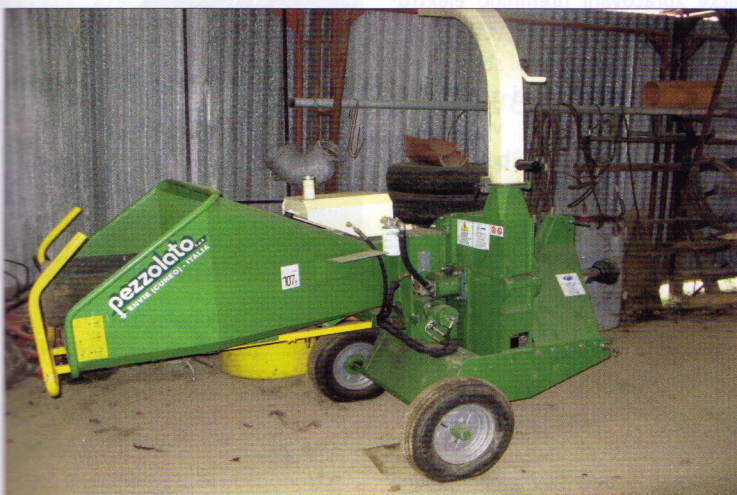
Jemná dezintegrace – štěpkovač PEZZOLATO PZ – 140 zpracuje dřevní hmotu do průměru 140 mm. Teoretická výkonnost dosahuje 6–8 m 3 /h (výkonnost závisí na vlastnostech a množství zpracovávaných surovin)
