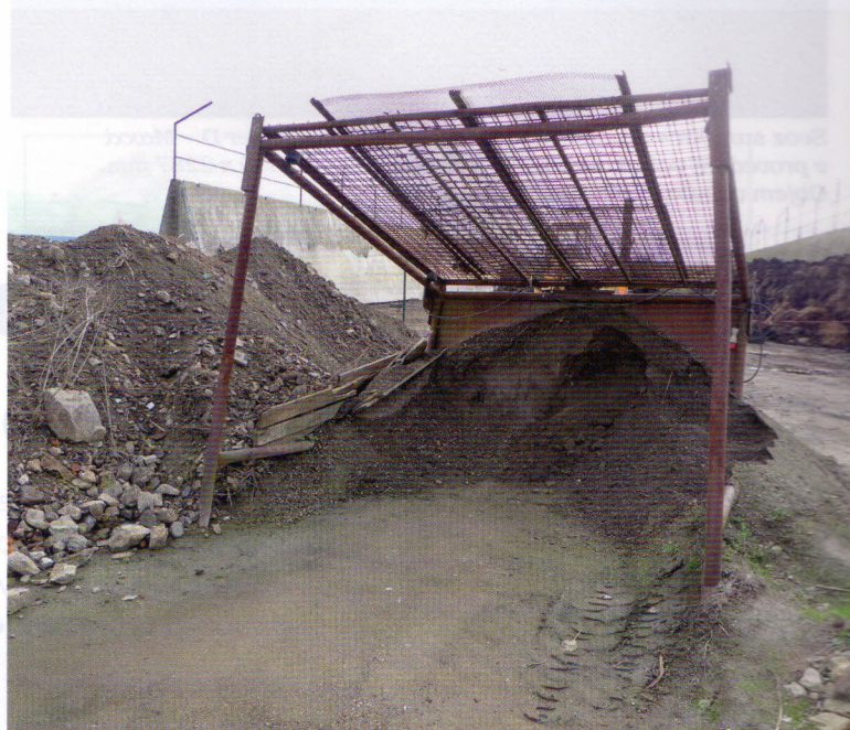
Prosévání vyrobeného kompostu – roviný vibrační třídící Ing. René HARTL – TCA s teoretickou výkonností 3–6 m 3 /h
