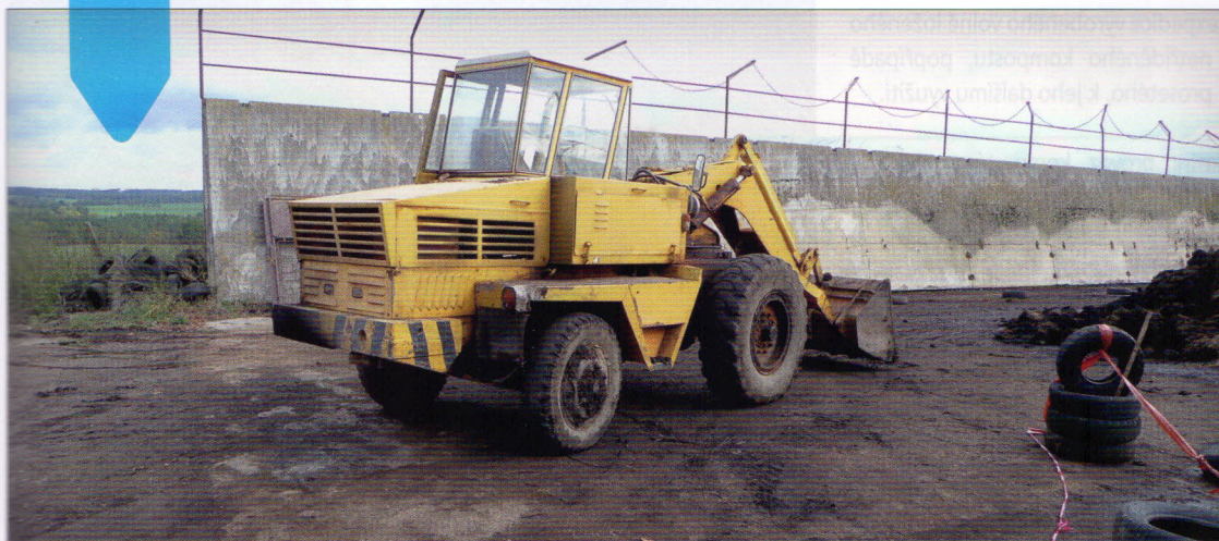
Manipulace se surovinami, překopávání kompostu – hydraulický otočný kolový nakladač HON 053 (47 kW) s objemem lopaty 0,75 m 3
