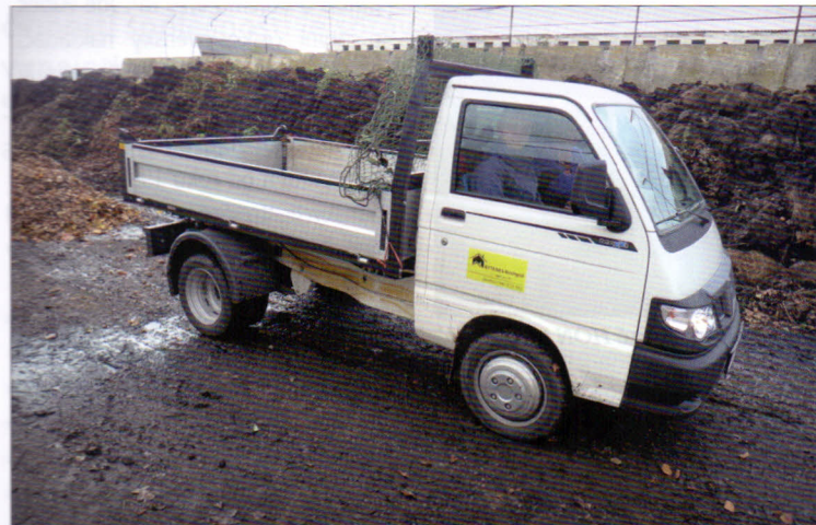
Svoz surovin – nákladní automobil PIAGGIO Porter D – Maxxi v provedení valník-sklápeč s ložnou plochou 1500 x 2287 mm. Objem valníku 1 m 3 , nosnost 1120 kg
