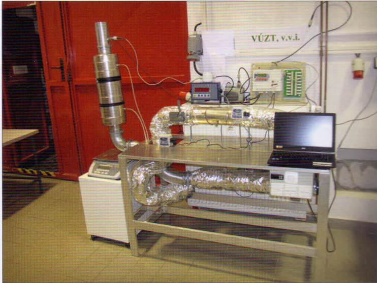
Obr. 5 - Experimentální sušárna VÚZT - měření energetické náročnosti sušení
