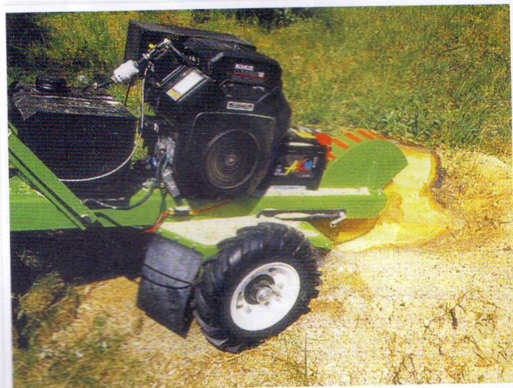
Obr. 2 – Odstraňování paty kmene pomocí pařezové frézy
