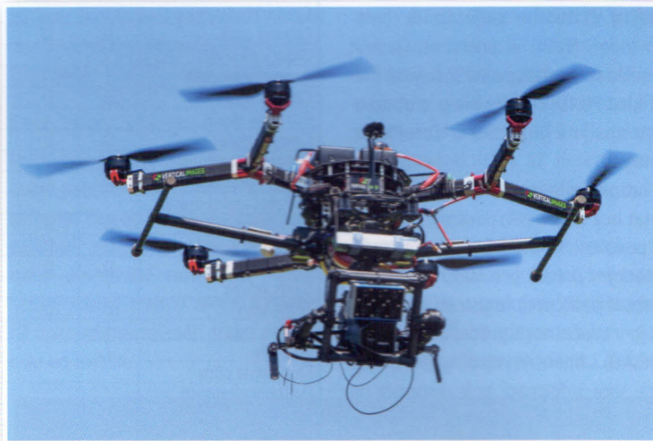
Plně vybavená hexakoptéra osazená senzorovou technikou v podobě termokamery, šestikanálové multispektrální kamery a přehledové RGB kamery, které jsou připevněny na podvěsu (gimbálu) zajišťujícím trojosou stabilitu a snímání v požadovaném úhlu a orientaci
