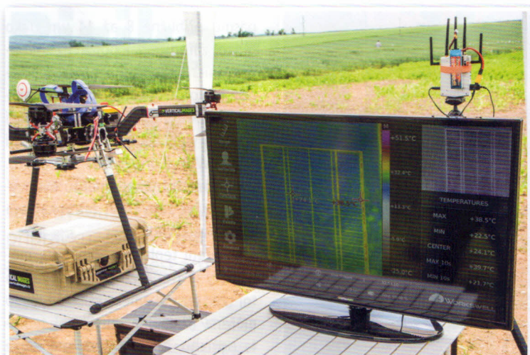
Okamžitá kontrola termogramu z termokamery pro okamžité vyhodnocení aktuálního stavu snímaného porostu
