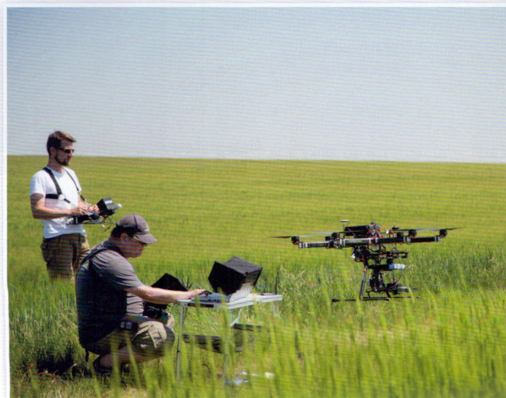
Pilot s operátorem při přípravě snímání pomocí softwaru umožňujícího velkoplošný sběr dat programováním trasy na základě GPS souřadnic
