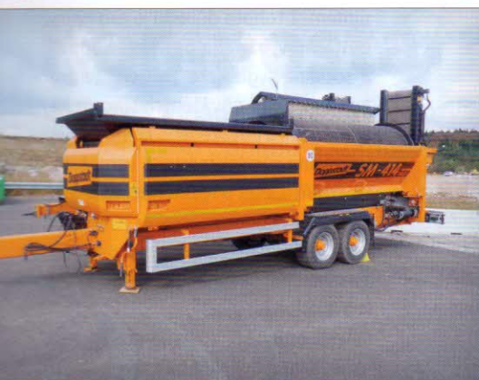
Prosévání kompostu – rotační třídič Doppstadt SM 414 s dieselovým motorem 30 kW a bubnem s oky 20 x 20 mm
