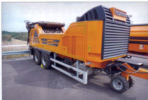
Jemná dezintegrace – rychloběžný drtič Doppstadt AK 235 s dieselovým motorem 175 kW, drticím bubnem (32 kladiv – dvě řady po 16 kladivech). Dodrcovací síto pracuje s oky 20 x 20 cm – kompost, a 6 x 6 cm – štěpka
