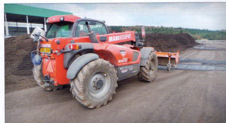
Manipulace se surovinami – teleskopický manipulátor MANITOU MLT 735-120LSU TURBO s dieselovým motorem PERKINS (91 kW), hydrodynamickým pohonem a výškou zdvihu 6,86 m. Vybavení – nakládací lopata 2,5 m 3 , lopata s přídržovačem 2 m 3 , paletovací vidle, zametací adaptér
