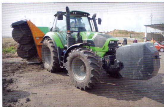
Energetický prostředek – kolový traktor DEUTZ-FAHR Agrotion 6160 (120 kW)
