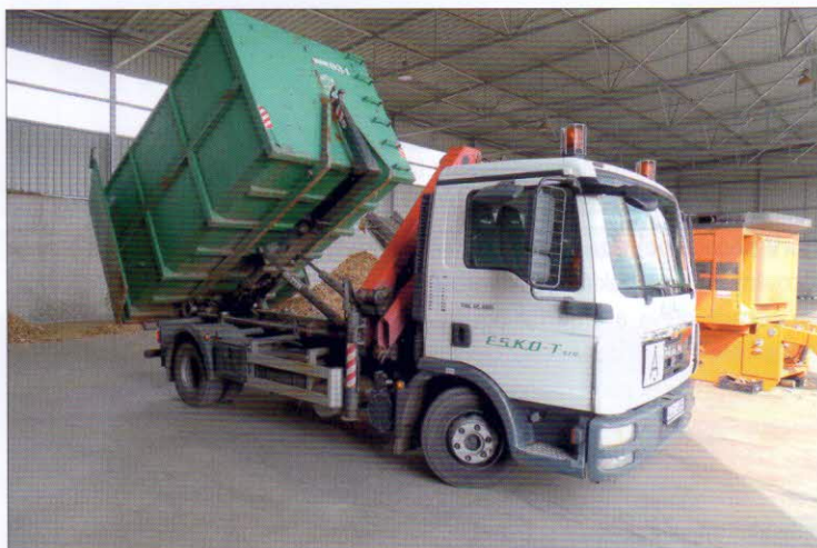
Přeprava surovin a vyrobeného kompostu – nákladní automobil MAN TGL 12.180 se zařízením pro svoz kontejnerů (objem 14 m 3 )
