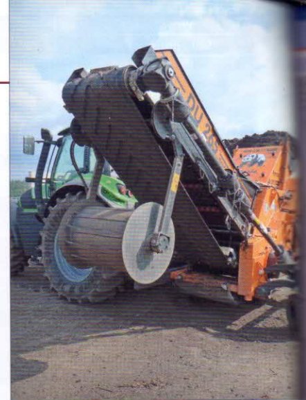
Překopávání kompostu – tažený překopávač kompostu Doppstadt DU 265 – Panda, s pracovním prostorem 5 x 3 m a účinností 300–500 m 3 /h
