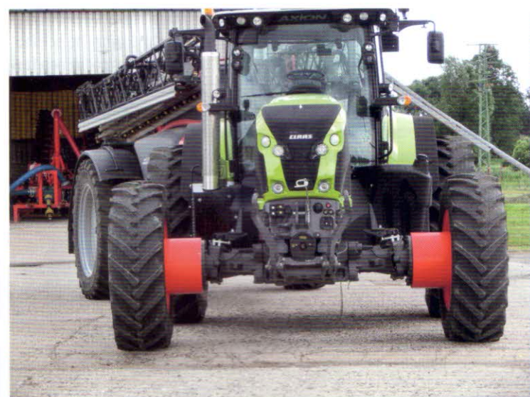
► Obr. 3 – Traktor a návěsný postřikovač s rozchodem kol přizpůsobeným sklízecí mlátičce
