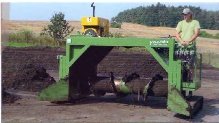
Překopávání kompostu – samojízdný překopávač kompostu PEZZOLATO PRS 2500 je poháněn dieselovým motorem HATZ 38kW, pracovní prostor má rozměry 2,5 x 1,4 m, rychlost pojezdu se pohybuje mezi 0 až 500 m/h. Výkonnost – 300 m 3 /h závisí na vlastnostech překopávaných surovin
