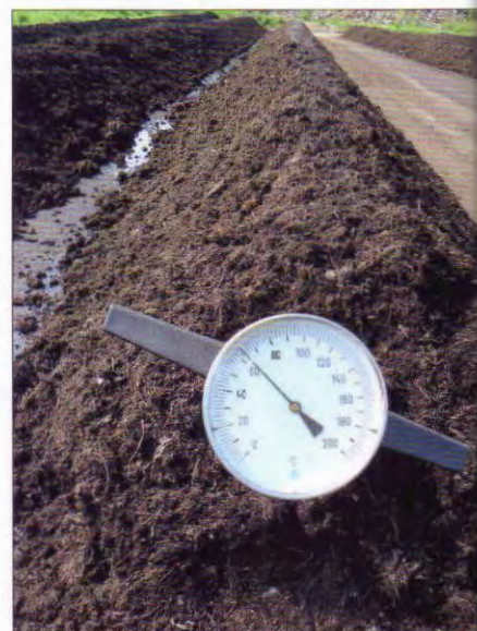
Měření teploty v hromadě kompostu
