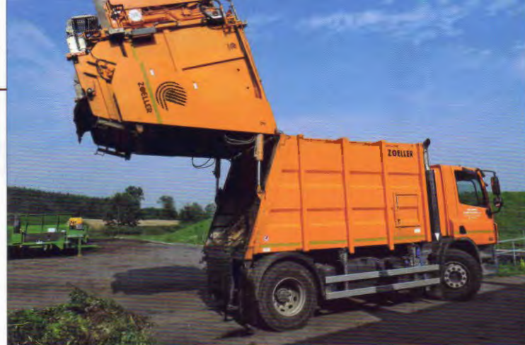
Přeprava BRKO – svozový nákladní automobil DAF 75.310 s vyklápěcím zařízením vyrobeným pro svoz BRKO z bionádob s objemem 240–1100 l
