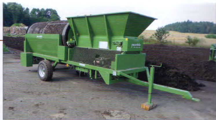
Prosévání kompostu – bubnový třídící PEZZOLATO L 3000 M s dieselovým motorem Lombardini 38kW a násypkou s kapacitou 3 m 3 . Velikost ok síta je 25 x 25 mm. Výkonnost dosahuje přibližně 30 m 3 /h (závisí na vlastnostech prosévaných surovin)
