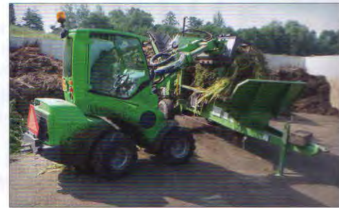
Manipulace se surovinami – kloubový nakladač AVANT M64 s výkonem motoru 26,5 kW a pojezdovou rychlostí 20 km/h. Pracuje s šířkou lopaty 1,3 m a výškou zdvihu 2,55 m
