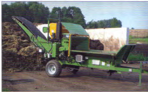
Jemná dezintegrace – drtič PEZZOLATO S 7000 s dieselovým motorem 50 kW zvládne zpracování dřevní hmoty s průměrem 20 cm. Drtič buben pracuje s 64 kladiv. Stroj má teoretickou výkonnost 20 m 3 /h
