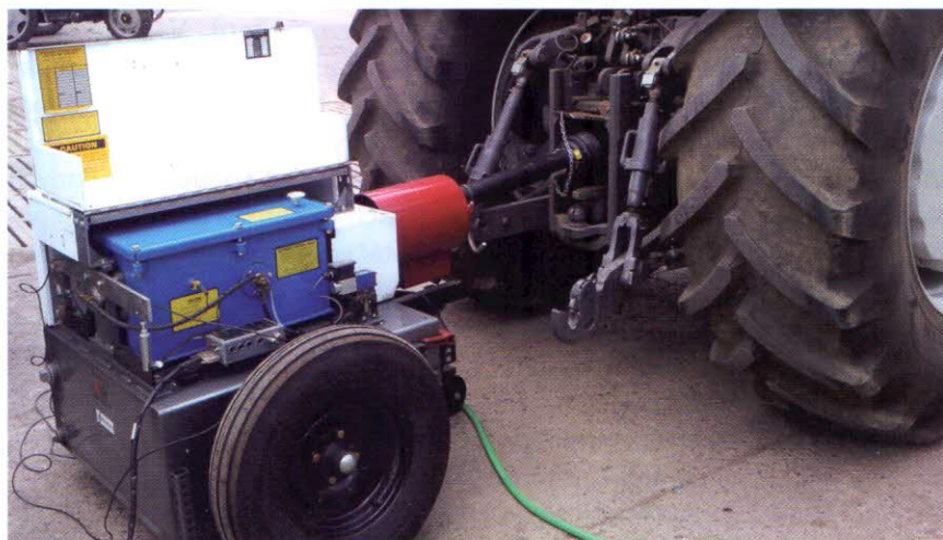
Obr. 4: Mobilní dynamometr NEB 400 při měření výkonu motoru traktoru
