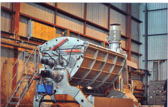
Obr. 5 – Přijímací nádrž s víkem o objemu 8 m 3 Foto archiv/DODA
