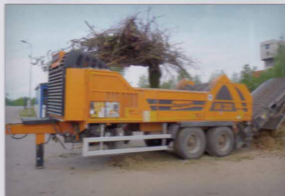
Jemná dezintegrace – drtič Doppstadt AK 430 se spalovacím motorem 314 kW. Drtičí buben pracuje s 28 kladiv, dodrcovací síto s oky 10 x 10 cm – kompost, 6 x 6 cm – štěpka
