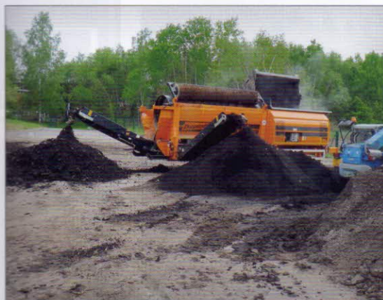
Prosévání kompostu – bubnový třídič Doppstadt SM 518 s násypkou 3 m 3 , buben s oky 20 x 20 mm
