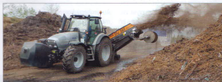
Energetický prostředek – kolový traktor LAMBORGHINI R6.160 DCE (120 kW)
