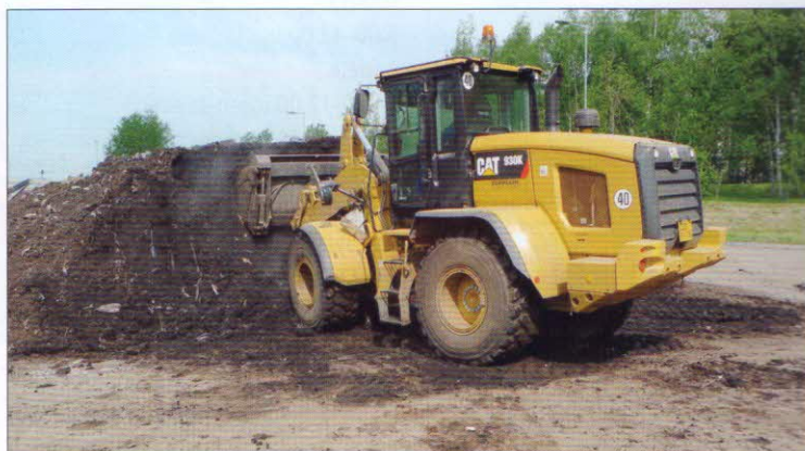
Manipulace se surovinami – kolový nakladač CATERPILLAR 930K s dieslovým motorem (119 kW), objemem lopaty 2 m 3 , 4 m 3 a provozní hmotností 1380 kg
