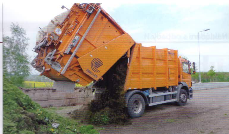
Přeprava surovin - svozový nákladní automobil Mercedes-Benz Axor LAX2 (210 kW) se zařízením pro svoz bioodpadů z bionádob (objem 240 l), po městě celkem rozmístěno více než 2000 nádob, a vyrobeného kompostu – nákladními automobily AVIA, LIAZ, MERCEDES v úpravě s nosičem kontejnerů
