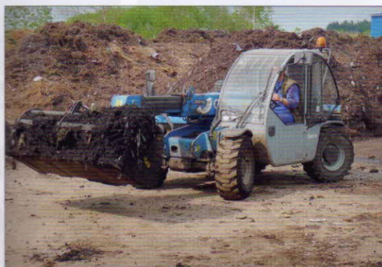
Manipulace se surovinami – kompaktní teleskopický manipulátor terénní Genie GTH™-2506 (50 kW) s nosností 2500 kg. Objem lopaty 0,56 m 3 (hlína), 1,2 m 3 (lehký materiál), výška zdvihu (max.) 5,75 m, čelní dosah (max.) 3,34 m, provozní hmotnost 4450 kg
