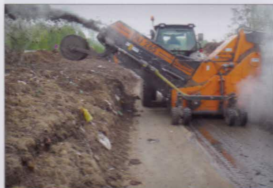
Překopávání kompostu – tažený překopávač kompostu Doppstadt DU 265 – Panda. Energetický zdroj – kolový traktor LAMBORHINI R6.160 DCE. Pracovní prostor překopávače 5 x 3 m, výkonnost dosahuje 300 m 3 /h
