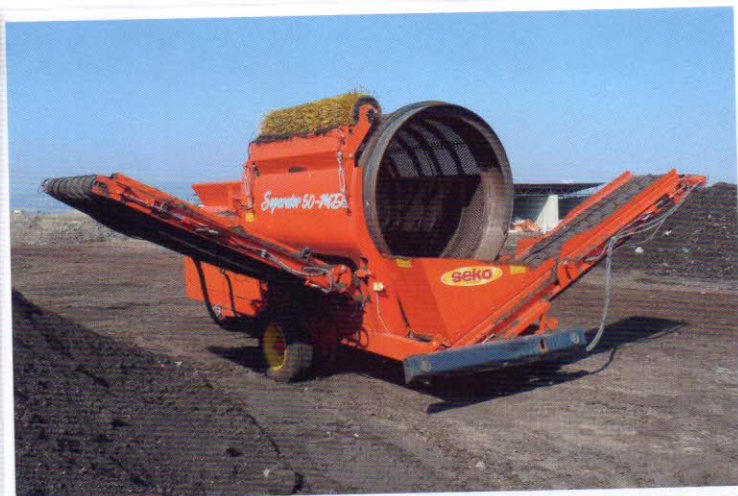
Prosévání kompostu – bubnové síto SEKO Separator 50 MD s dieselovým motorem 62 kW a třídícím výkonem do 50,0 m 3 /h (velikost oka síta 30 x 30 mm)
