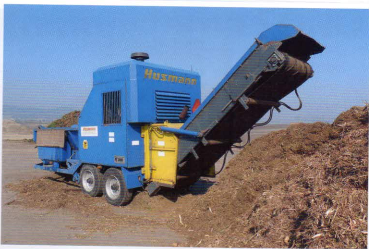
Jemná dezintegrace – velkoobjemový drtič HUSMANN HGF IV (dieselový motor 164 kW, násepka 2 m 3 )
