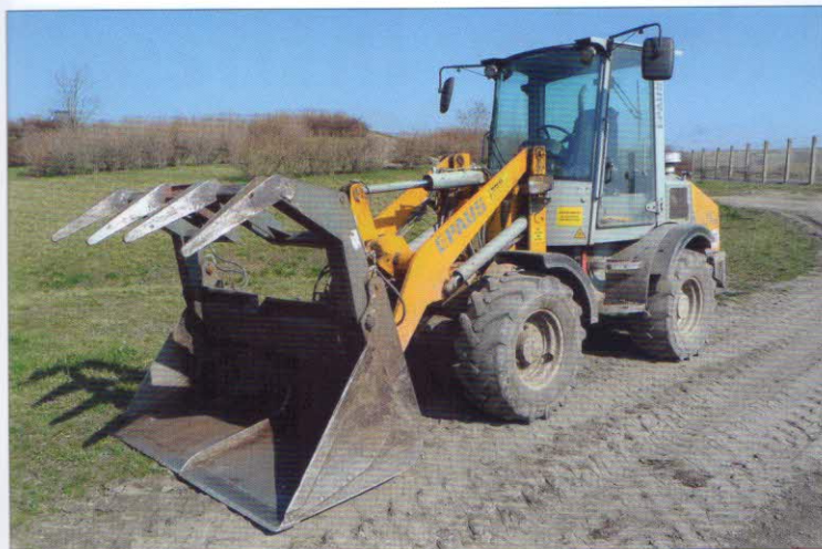
Manipulace se surovinami – čelní kolový nakladač PAUS RL 655 s dieselovým motorem 50 kW a objemem lopaty 2 m 3
