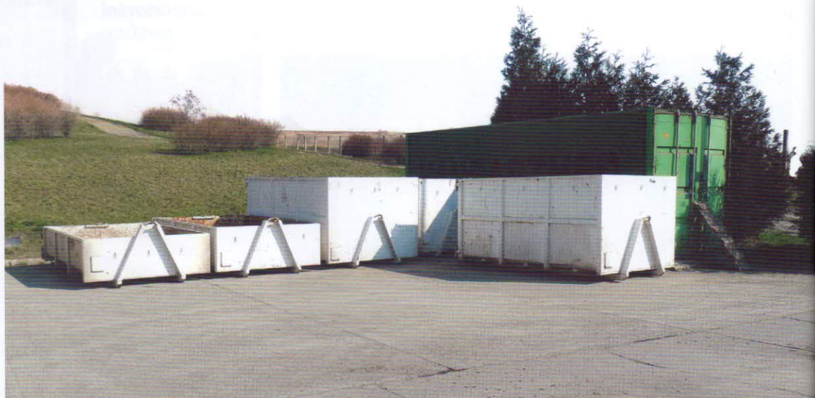
Svoz zpracovávaných surovin – kontejnery pro svoz bioodpadu VLK Brozany s. r. o. Ocelový kontejner typ BIO (10 kusů) má objem – 8,5 m 3 , ocelový kontejner typ Normal (3 kusy) má objem 9,5 m 3
