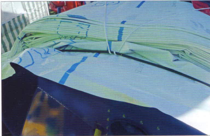
Kompostovací vaky Eurobagging s maximální délkou 60 m a průměrem 1,5 m. Úložná kapacita vaku je asi 80 t, vak je určen k jednomu naplnění, fólie vaku je recyklovatelná
