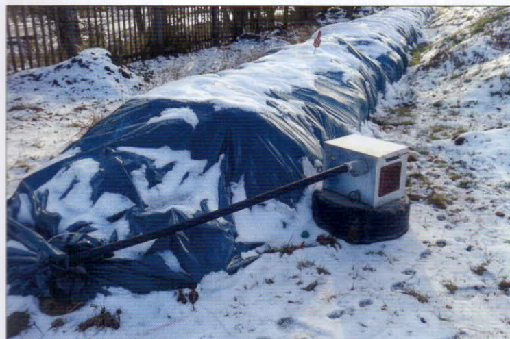
Systém pro provzdušňování – ventilátor s řídicí jednotkou zajišťuje regulované provzdušňování, provzdušňovací hadice (materiál PE) má průměr 90 mm, délku 60 m, hadice se používá opakovaně. Vestavěné ventilační průduchy jsou též opakovaně použitelné
