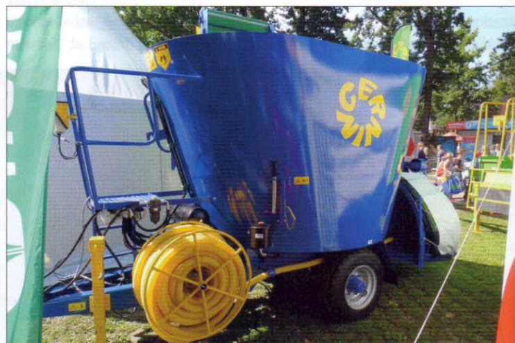
Drcení, promíchávání a homogenizace surovin, plnění kompostovacích vaků – mobilní kompostárna CERNIN MK 7 s objemem pracovního prostoru 7 m 3 a výkonností 42 m 3 /h. Zařízení pracuje s jedním šnekem, je vybaveno hydraulickou rukou a pásem
