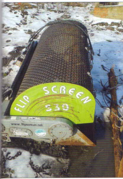
Prosévání kompostu – prosévací lopata FLIP SCREEN MODEL S 30 má pracovní šířku 1600 mm a objem 0,3 m 3 (velikost ok síta 17–75 mm)
