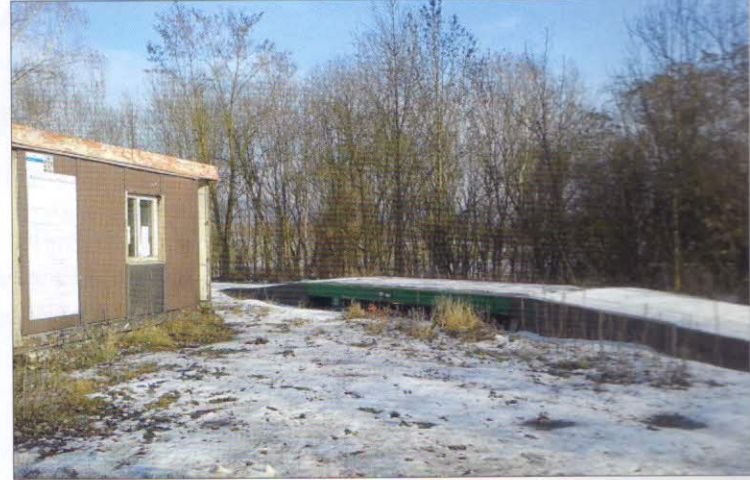
Evidence přijímaných surovin a expedovaného kompostu – silniční mostní váha PROFÍ 7x3/30t s váživostí do 30 t a přesností ± 10 kg
