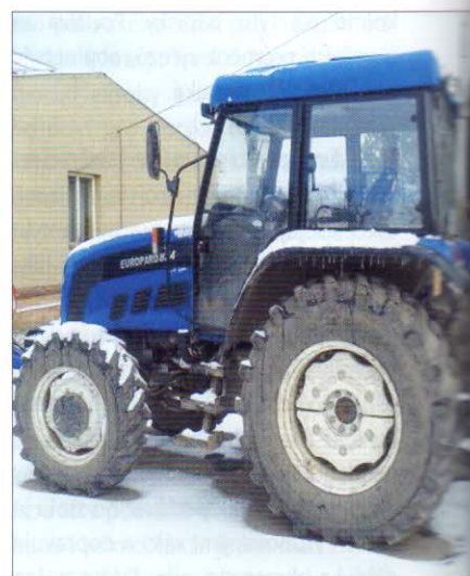
Energetický prostředek – kolový traktor Foton Europard TD824 s výkonem 66 kW
