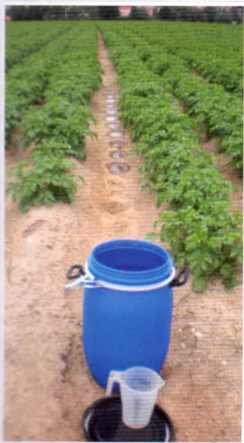
Obr. 4 – Měření objemu vyrýpnutých jamek v kolejevých brázdách záhonu po hrázkování
