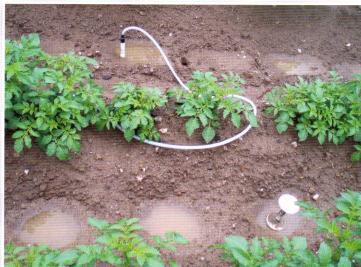
Obr. 5 – Umístění vlhkostních čidel TMS-3 pro stahování dat vlhkosti a teploty
