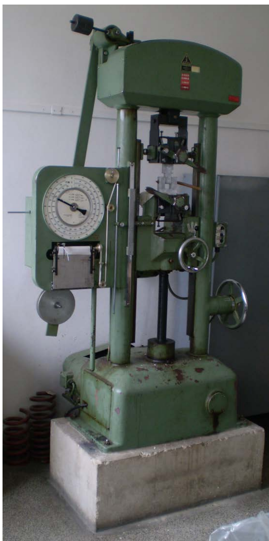
Obr. 5.: Mechanický trhací stroj používaný při měření
