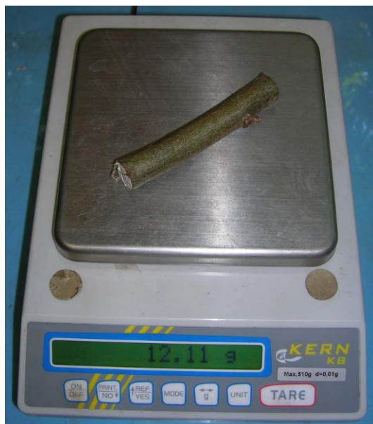
Obr. 4.: Stanovení hmotnosti etalonu na laboratorních vahách.
