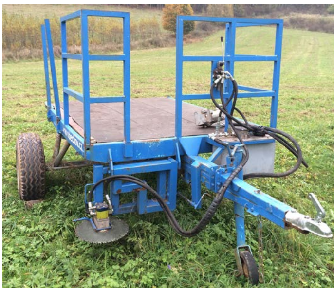
Obr. 14: Pilotní zařízení pro sklizeň rrd v alternativě s manuálním odběrem a vlastním hydraulickým obvodem
