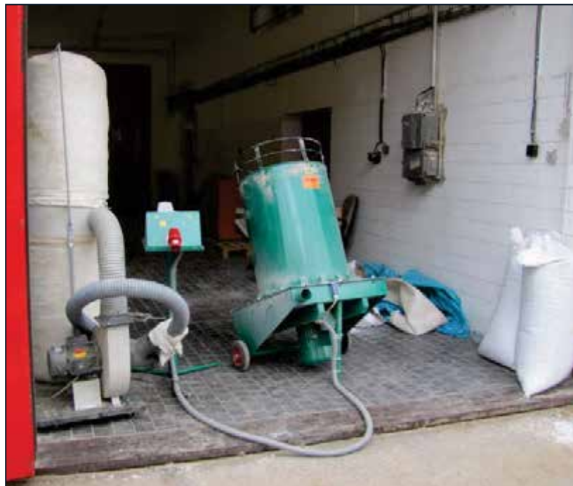
Desintegrace lněného stonku – řezací šrotovnic RS 650 s vertikální osou rotace
