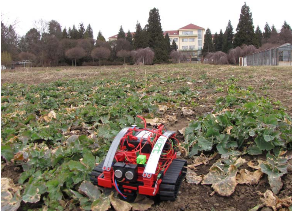
Obr. 2: Robotická stavebnice pro testování aplikací a senzorů
