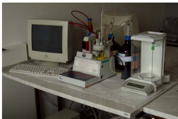
Obr. 25: Sestava použitého automatického titrátoru pro stanovení obsahu vody v pyrolýzním oleji
