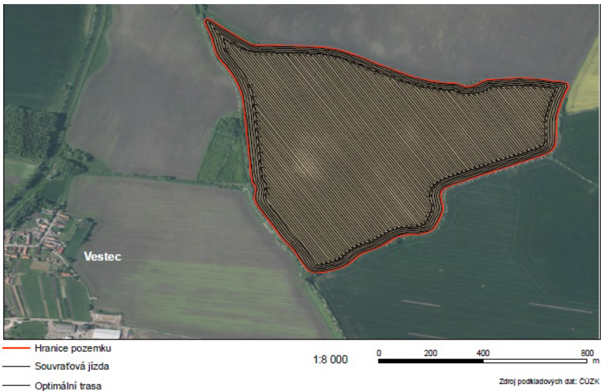
Obr. 11: Návrh trasy pohybu strojních souprav při pracovním záběru 6 m, včetně souvrátí – pozemek s nepravidelným tvarem
