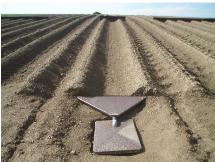
Obr. 19: Zakládání polního pokusu na měření eroze po dešti během vegetace na pozemcích VÚB ve stanici Valečov
