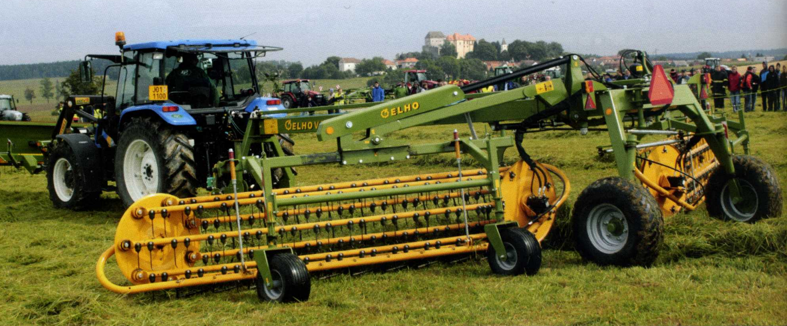
Netradiční provedení shrnovače. Rotorový s horizontální osou rotace
