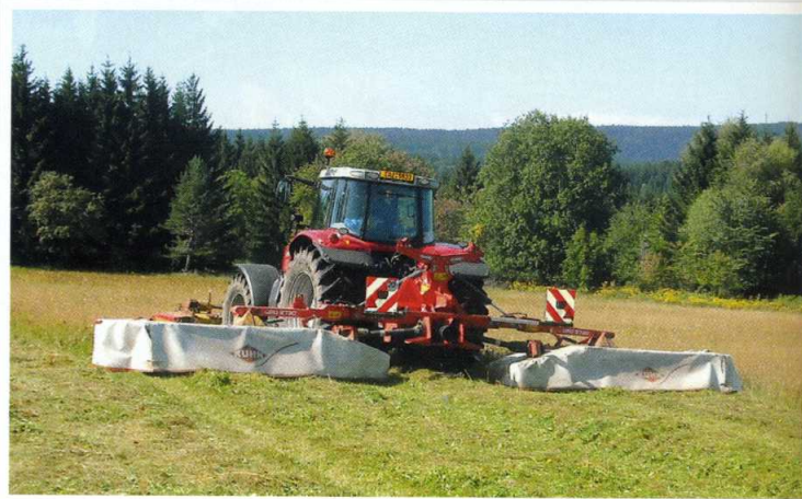
Trojkombová žací stroje dosahují pracovní záběr mezi 8 až 9 m
