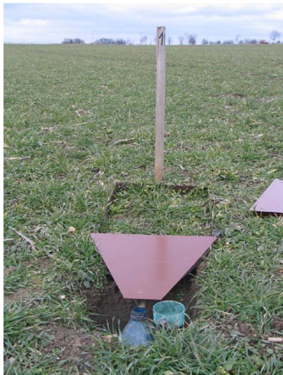
Obr. 1: Minisběrač instalovaný na plochu pokusu po vzejití pšenice ozimé
