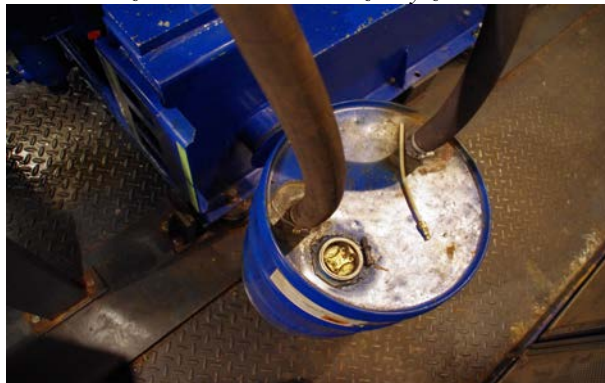
Obr. 4: Provizorní zvýšení objemu mazacího oleje pro dosažení větší jímavosti síry
