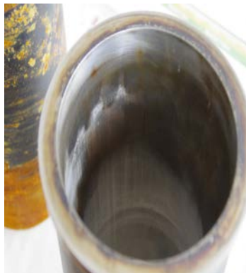
Obr. 2: Vložka válce motoru s náznaky zadírání
