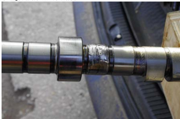
Obr. 1: Mechanické poškození vačkové hřídele
