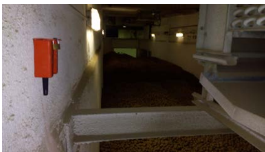
Obr. 1: Měření teploty a vlhkosti záznamovým měřicím zařízením ve skladovacím boxu
