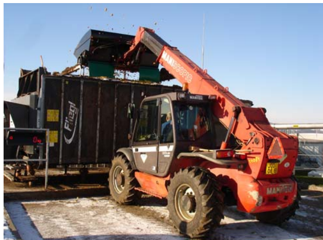
Obr. 4: Drcení hlíz do dávkovače BPS Senožaty
