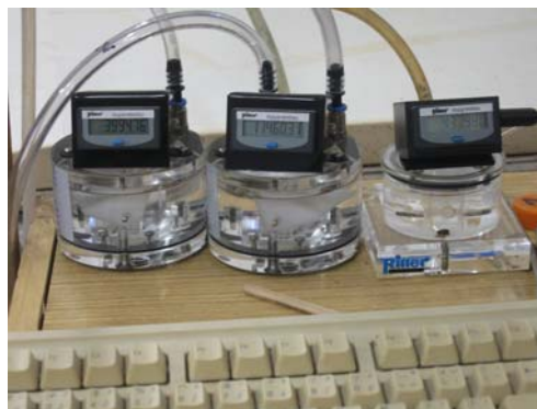
Obr. 2: Měření množství plynu pomocí nízkoprůtočných plynoměrů
