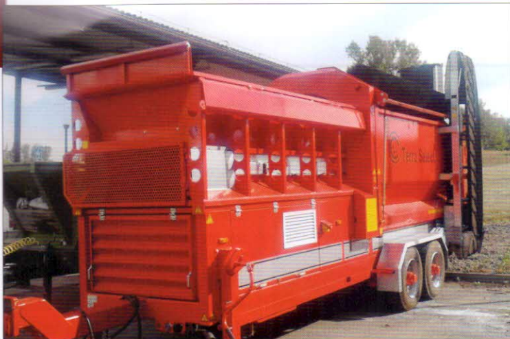
Prosévání kompostu – bubnový třídíč Terra Select T4 s dieselovým motorem 62 kW a třídícím výkonem do 100 m 3 /h. Pracuje s velikostí ok síta 15 x 15 mm
