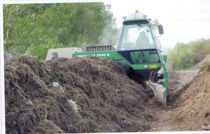
Překopávání kompostu – samojízdný překopávač kompostu Compost Systems GmbH TOPTURN 3500 (dieselový motor 96,5 kW) má pracovní prostor (š x v) – 3,0 x 1,8 m a výkonnost 1000 m 3 /h
