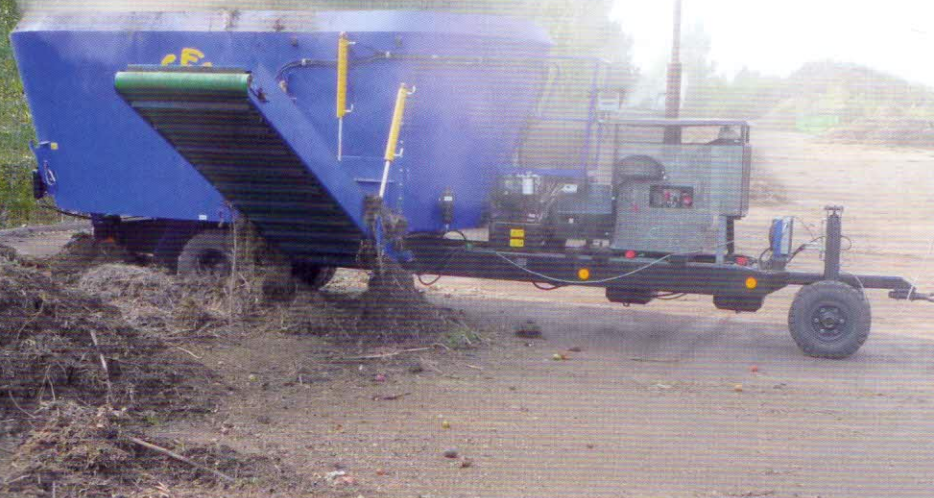
Promíchávání a homogenizace surovin – dezintegrátor s pojezdovým ústrojím BRO CERNIN s dieselovým motorem 50 kW, objemem pracovního prostoru 18 m 3 a výkonností 50 m 3 /h podle vlastností materiálu
