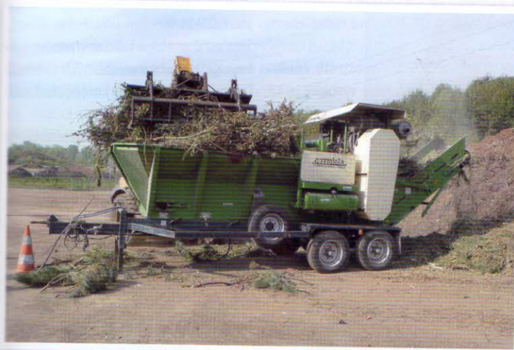
Jemná dezintegrace – drtič biomasy PEZZOLATO S 9000 M (dieselový motor 112 kW) má výkonnost 30–40 m 3 /h, je vybaven elektronickou pojistkou přetížení No Stress a dodrčovacími protiostrými
