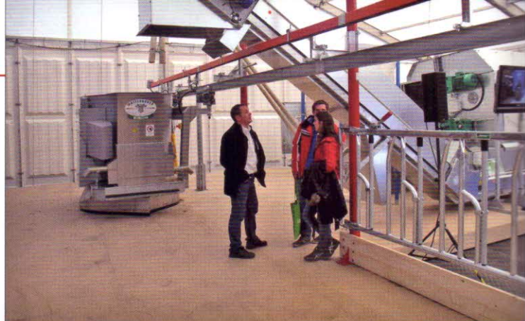
Poloautomatický systém rakouské firmy Wasserbauer Mixmeister 3000 má vlastní podvozek a jeho pohyb je řízen subtilní vodící kolejnici. Dávkuje krmivo do žlabu a současně přihřnuje jeho zbytky. Je také vybaven dávkovačem krmných a minerálních směsí, které může zakládat na zbytky krmiva ve žlabu, čímž zlepší jejich využití
