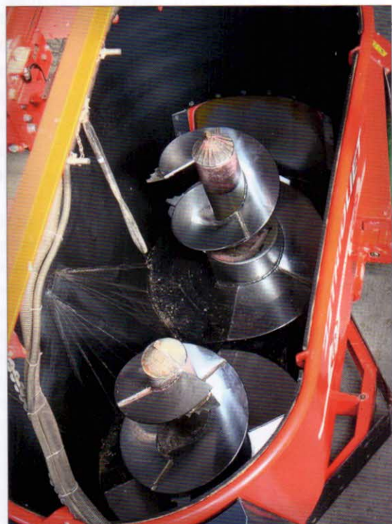
Robotizovaný krmný vozík, který je základním prvkem poloautomatických systémů TRIOLIET, využívá pro míchání a vyskladňování dva vertikální míchací šneky uspořádané v korbě o objemu 3 m 3
