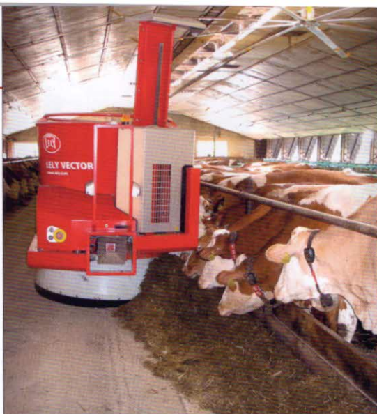
Lely Vector krmivo ve stáji zakládá a přihruje nebo jen přihruje v závislosti na množství zbytků krmiva ve žlabu (laserové čidlo snímá výšku vrstvy krmiva ve žlabu)
