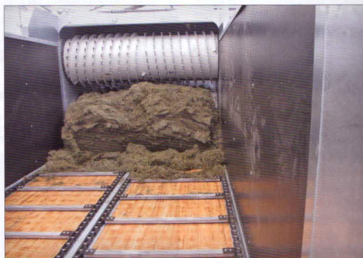
Poloautomatický systém rakouské firmy Wasserbauer Mixmeister 3000 využívá v přípravě krmiva několik paralelně uspořádaných dávkovacích zásobníků s vodorovným dnem. To umožňuje ukládat jednotlivé bloky krmiva těsně za sebou a nevzniká tak nebezpečí převrácení nebo rozpadnutí bloku krmiva při frézování a dávkování
