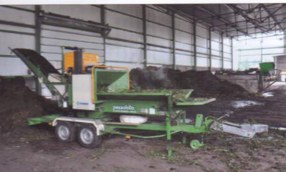
Drcení dřevní hmoty – drtič PEZZOLATO S7000 je poháněn motorem HATZ (70 k), výkonnost dosahuje 20 m 3 /h
