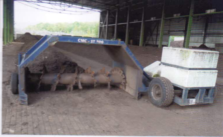
Překopávání kompostu – tažený překopávač kompostu CMC ST 300 v agregaci s traktorem. Pracovní prostor (3,0 × 1,5 m, výkonnost zhruba 1000 m 3 /h)
