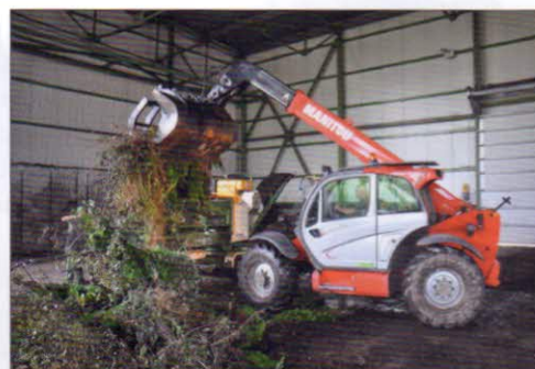
Manipulační prostředek – nakladač – teleskopický nakladač MANITOU MT 835 s dieselovým motorem PERKINS (102 k), pohonem 4 x 4 a výškou zdvihu 7,75 m
