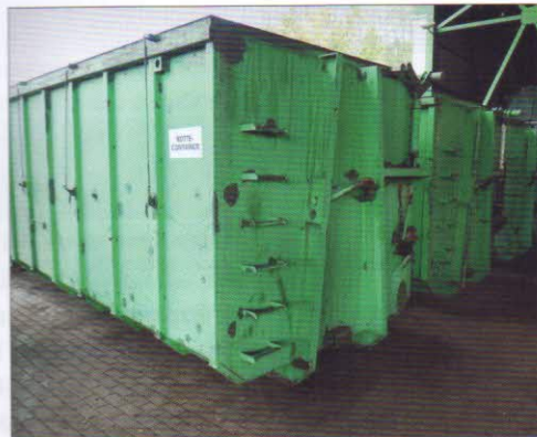
Kompostování pomocí systému KNEER. Osm mobilních kontejnerů, objem jednoho kontejneru je 25 m 3
