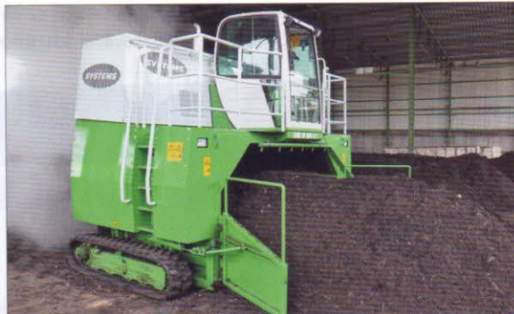
Překopávání kompostu – samojízdný překopávač kompostu CMC SF 300 MD poháněn dieselový motor PERKINS (131 k). Pracovní prostor má rozměry 3,0 × 1,6 m. Výkonnost – 1000 m 3 /h
