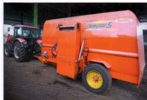
Promíchávání a homogenizace surovin – míchací stroj SEKO SAM 5500/150 GC/T s objemem pracovního prostoru 15 m 3
