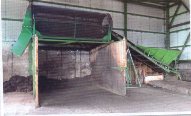
Prosévání kompostu – bubnové síto Compost Systems GmbH KA 4018 s elektromotorem 11 kW, výkonnost 120 m 3 /h
