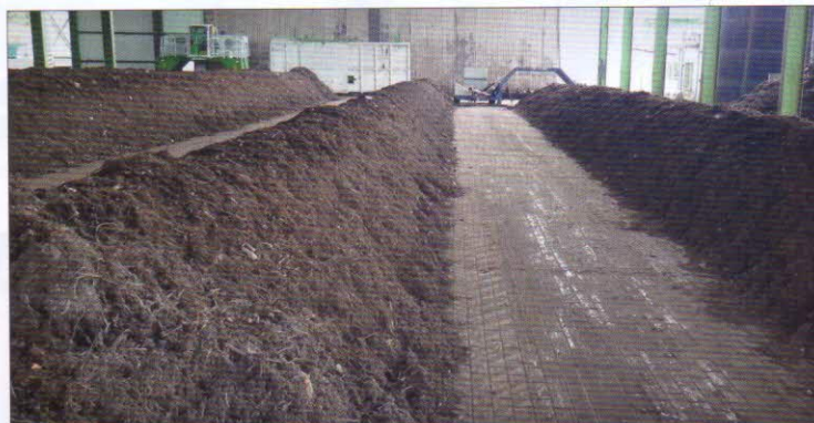
Kompostovací plocha – vodohospodářsky zajištěná betonová plocha s betonovou zámkovou dlažbou o rozměrech 24 × 45 m je umístěna uvnitř montované haly vysoké 10 m. Z důvodu ovlivňování okolí kompostárny hlukem a zápachem je hala vybavena bočními stěnami. Kapaliny, vznikající během kompostovacího procesu, mohou být sváděny do nádrže ČOV, která bezprostředně sousedí s halou
