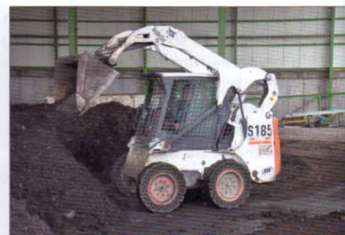
Manipulační prostředek – nakladač – smykem řízený nakladač BOBCAT S185 s dieselovým motorem KUBOTA /58 k) a hydrostatickým pojezdem
