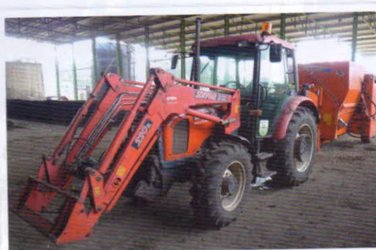
Energetický prostředek/nakladač – kolový traktor Zetor 7341.1 PVH s dieselovým motorem ZETOR EKO a výkonem 77,5 k, je vybaven čelním nakladačem Track-Lift TL-220
