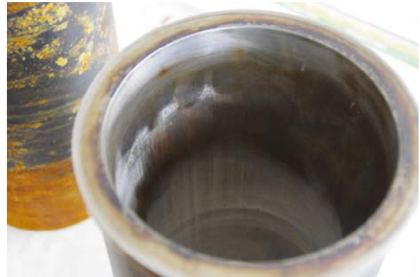
Obr. 2: Vložka válce motoru s náznaky zadření Cylinder Engine with signs of seizure
