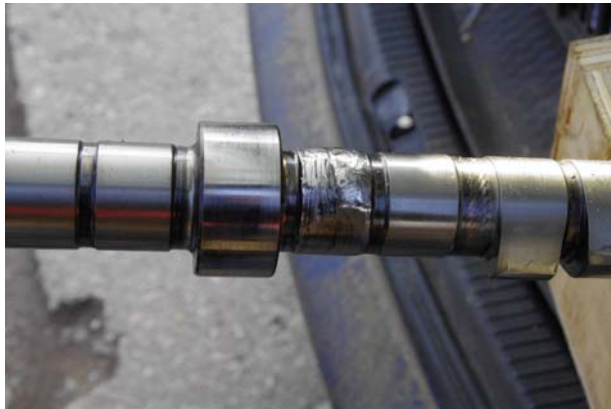
Obr. 1: Mechanické poškození vačkové hřídele Mechanical damage to the camshafts
