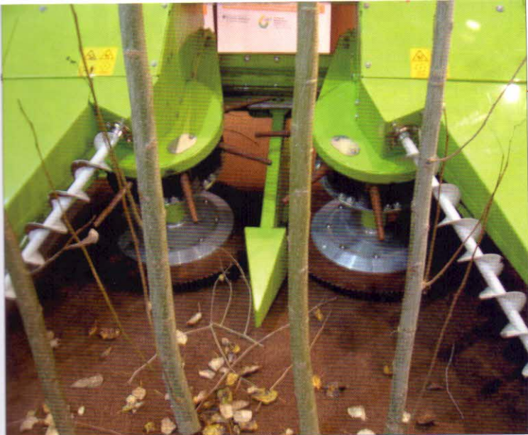
Obr. 8 – Sklízecí adaptér s dvěma řezacími kotouči a aktivním děličem umožňující sklizeň více řádků RRD při jednom přejezdu.
