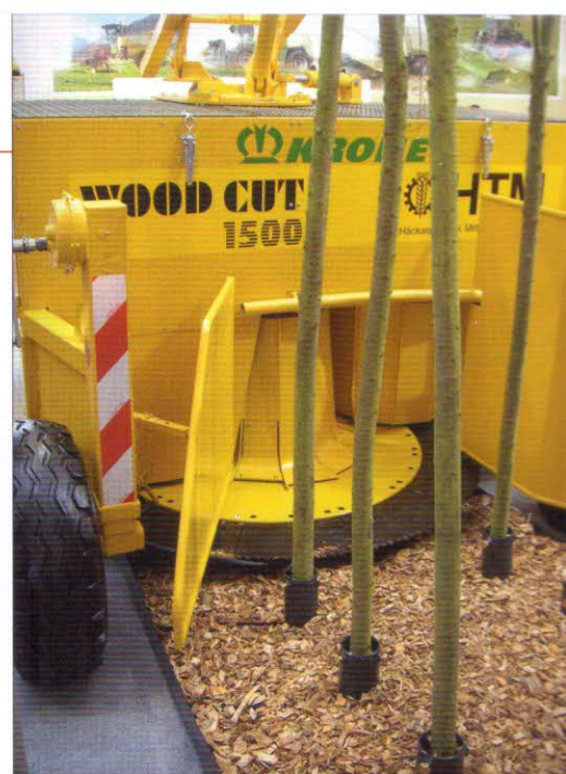
Obr. 7 – Řezací mechanismus sklízecího adaptéru s jedním pilovým kotoučem
