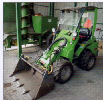
Manipulace se surovinami – kloubový nakladač AVANT 635 (25 kW) s šířkou lopaty 1,2 m
