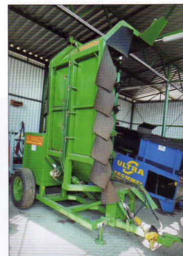
Překopávání kompostu – překopávač kompostu RIVO CARAVAGGI US-2500 poháněný vývodovým hřídelem traktoru. Pracovní prostor 2,5 x 1,4 m
