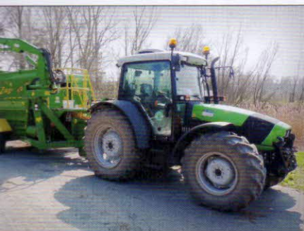
Energetický prostředek - kolový traktor DEUTZ – FAHR Agrofarm 420 (73 kW)
