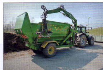
Promíchávání a homogenizace surovin – drtič biomasy ECOGREEN – Zago 9 SD GRU
