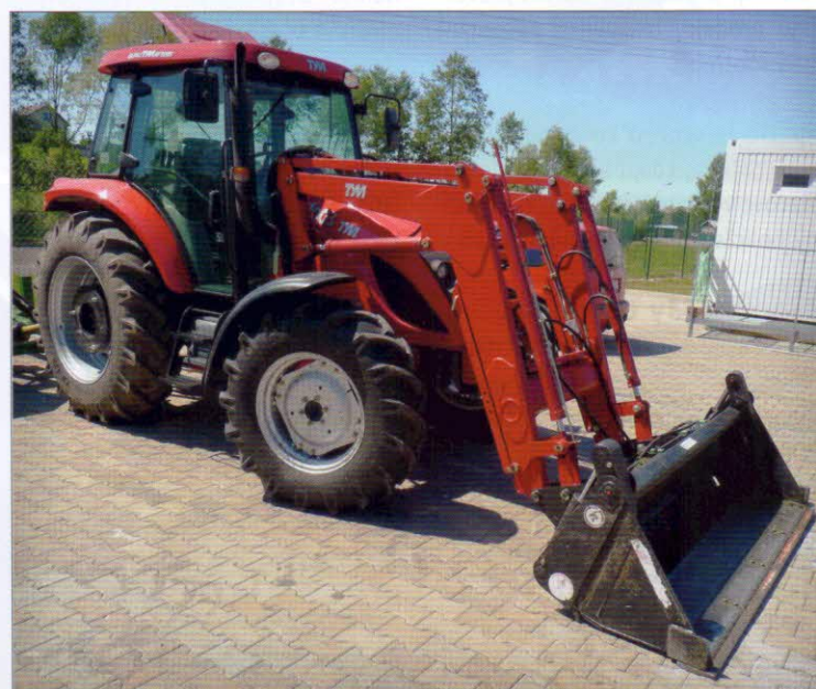
Energetický prostředek – kolový traktor TYM T1003 s motorem Perkins a výkonem 74,5 kW při 2200 ot/min. Čelní nakládací lopata má objem 0,5 m 3
