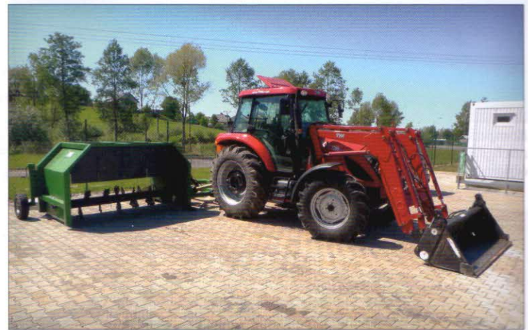
Překopávání kompostu – překopávač kompostu RIVO CARAVAGGI 3000 je poháněn vývodovým hřídelem traktoru, pracovní prostor má kapacitu 2,5 x 1,4 m
