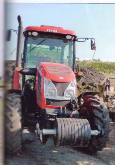
Energetický prostředek – kolový traktor Zetor Proxima 110 plus (jmenovitý výkon 78,4 kW)
