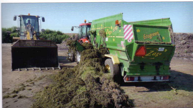
Promíchávání a homogenizace surovin – drtič biomasy ECOGREEN – Zago 11SD. Pohon traktorem s minimálním výkonem 60 kW, objem pracovního prostoru – 11 m 3 , výkonnost asi 30 m 3 /h. Drtič je vybaven automatickou váhou, drticími a míchacími šneky
