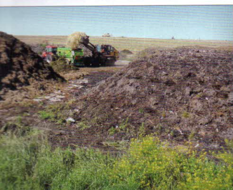
Technologie kompostování – kompostování na volné ploše. Překopávání zpracovávaných surovin v plošných hromadách kolovým nakladačem CAT 924H. Doba kompostování jeden až dva roky. Vodohospodářsky zajištěná plocha 11 800 m 2 má kapacitu 15 000 m 3 kompostu (objem jímky – 150 m 3 )
