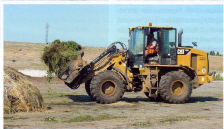
Manipulace se surovinami – kolový nakladač CAT 924H s objemem lopaty 1,8 m 3 a výkonem motoru 105 kW
