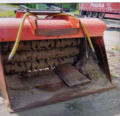
Prosévání a homogenizace surovin – třídicí a drtičí lopata IDEACHIP Oyj ALLU DN3/17 (Finsko) s požadovaným příkonem 20 kW, výkonnost 3–6 m 3 /h (závisí na vlastnostech proséváných surovin)
