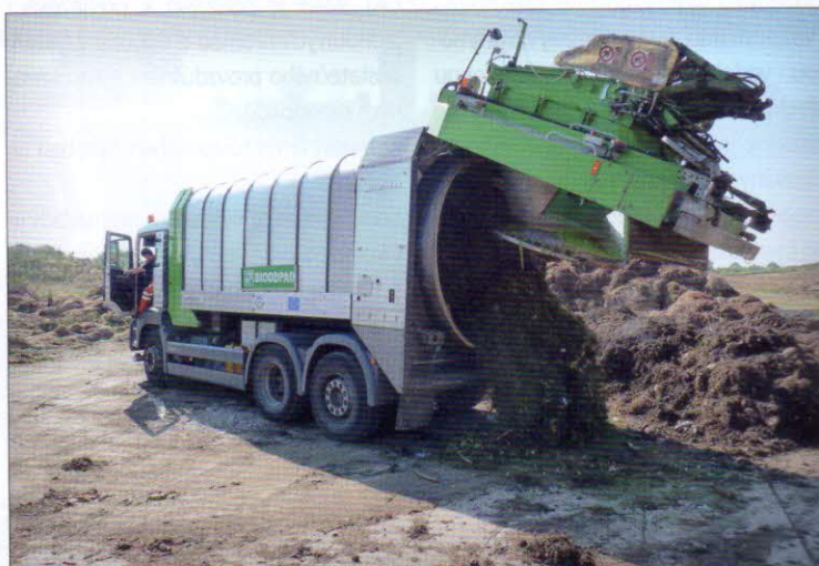
Svoz surovin – nákladní automobil MAN TGS 28.400 s nástavbou pro výsyp nádob FAUN ROTOPRESS 518 (celkový objem 21 m 3 ) a zařízením na vyprázdnění a vmytí nádob v rámci jedné operace
