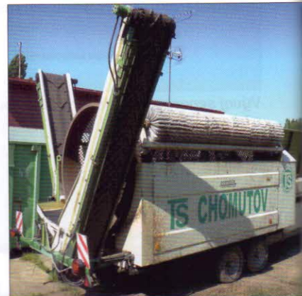
Prosévání kompostu – bubnový třídič PEZZOLATO L 3500 se vznětovým motorem 37 kW. Velikost oka síta 20 x 20 mm, 30 x 30 mm, výkonnost 8 m 3 /h (závisí na vlastnostech proséváných surovin)
