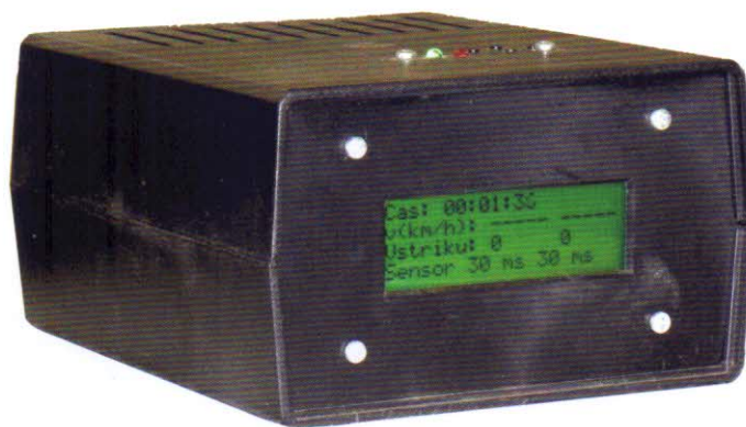
Obr. 1 – Provedení funkčního vzorku ovládací skříňky řídicí jednotky elektronického modulu dávkovacího aplikačního zařízení přípravků pro postřik hlíz v sázecím ústrojí sázeče brambor
