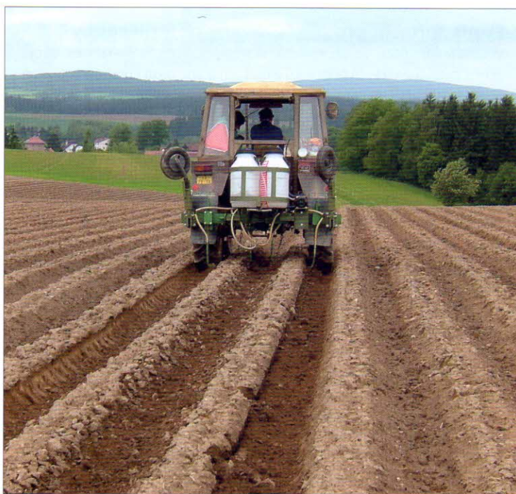
Obr. 5 – Přihnojování polních pokusů přesnou aplikací kapalných hnojiv do půdy funkčním vzorkem aplikátoru
