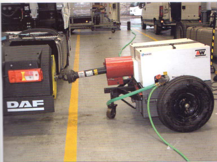
Obr. 3 - Při měření se dynamometr připojil na zadní hnací nápravu přes speciální přírubu
