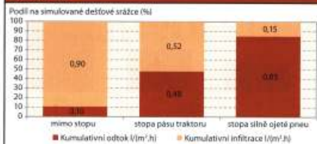
Graf 1: Porovnání podílů povrchového odtoku vody a infiltrace do půdy na úhrnu simulované dešťové srážky 87 mm za dobu kroupení 60 minut podle míry zhuštění: těžká písčitojilnatá půda, svah 3,5–4,0°
