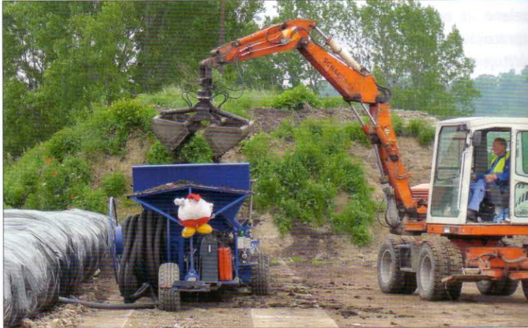
Plnění kompostovacích vaků - kompostovací lis EURO BAGGING CM 1,5 se spalovacím motorem 11,0 kW, objemem násypky 2,7 m 3 a výkonností 12 - 40 t/h
