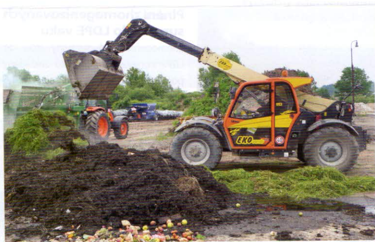
Manipulace se surovinami – Manipulátor JLG 3707PS s dosahem 7 m, výkonem motoru – 92,5 kW a objemem lopaty 1,5 a 2,5 m 3
