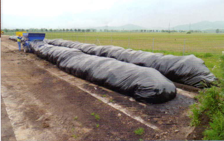
Kompostovací vaky EURO BAGGING (ČR), rozměry - délka 60 m, průměr 1,5 m, tloušťka fólie 0,9 mm. Úložná kapacita vaku je přibližně 60 t (1,5 x 60) m. Vak je určen k jednomu naplnění, fólie vaku je recyklovatelná
