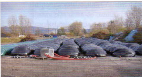
Systém pro provzdušňování - ventilátor s řídicí jednotkou zajišťuje regulované provzdušňování, provzdušňovací hadice z PE materiálu má průměr 90 mm a délku 60 m. Hadice je určena k jednomu naplnění, použitá hadice je recyklovatelná. Vestavěné ventilační průduchy z PE materiálu jsou opakovaně použitelné
