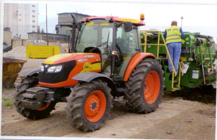
Energetický prostředek – kolový traktor KUBOTA M9540 o výkonu motoru 70,8 kW
