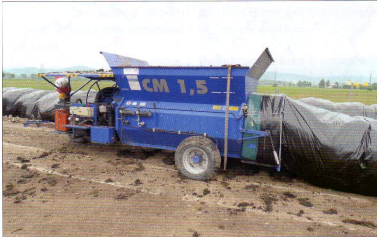
Plnění kompostovacích vaků - kompostovací lis EURO BAGGING CM 1,5 se spalovacím motorem 11,0 kW, objemem násypky 2,7 m 3 a výkonností 12 - 40 t/h
