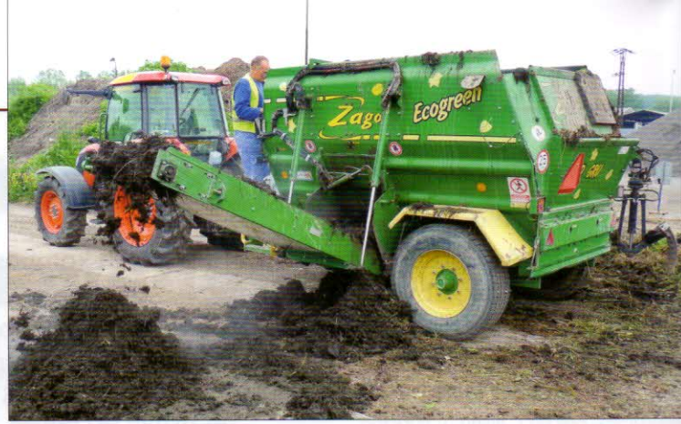
Promíchávání a homogenizace surovin - drtič biomasy ECOGREEN - Zago 13SD GRU vybaven drapákem má pracovní prostor 13 m 3 a výkonnost - 55 m 3 /h. Požadovaný výkon traktoru je min. 60 kW
