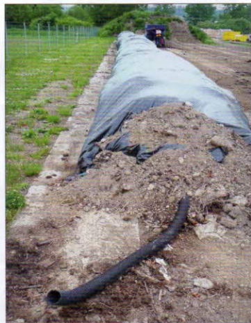
Systém pro provzdušňování - ventilátor s řídicí jednotkou zajišťuje regulované provzdušňování, provzdušňovací hadice z PE materiálu má průměr 90 mm a délku 60 m. Hadice je určena k jednomu naplnění, použitá hadice je recyklovatelná. Vestavěné ventilační průduchy z PE materiálu jsou opakovaně použitelné
