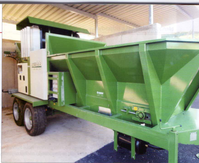
Jemná dezintegrace surovin – drtič biomasy Pezzolato S 9000 M s dieselovým motorem o výkonu 170 k. Objem pracovního prostoru je 5 m 3 . Výkonnost dosahuje 35 m 3 /h. Stroj je vybaven elektronickou pojistkou přetížení No Stress a dodrčovacím protiotřím
