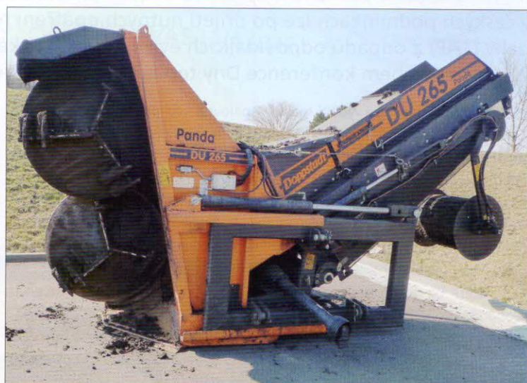
Překopávání kompostu – nesený překopávač kompostu Doppstadt DU 265 – Panda pracuje v agregaci s kolovým traktorem New Holland T7.220. Překopávač s pracovním prostorem 5 x 3 m má výkonnost 400 m 3 /h
