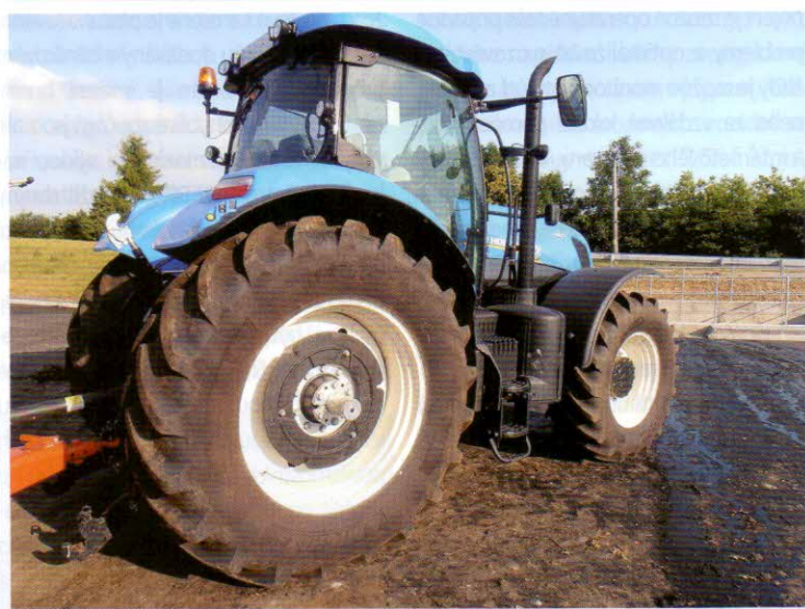
Energetický prostředek – kolový traktor New Holland T7.220 s výkonem motoru 160 kW
