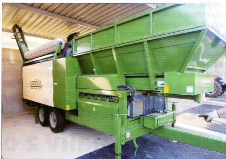
Prosévání kompostu – bubnový třídič Pezzolato typ L 3000 M s dieselovým motorem (51 k). Výkonnost třídiče se sítí s velikostí ok 25 x 25 mm dosahuje zhruba 30 m 3 /h
