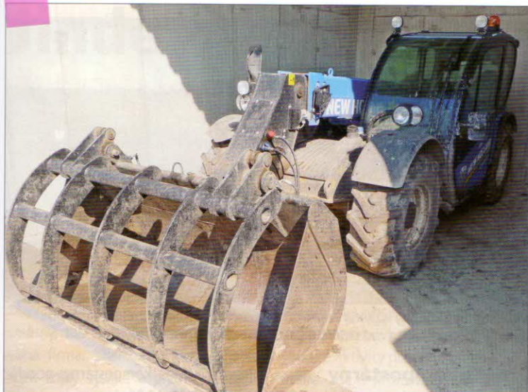
Manipulace se surovinami – teleskopický nakladač New Holland LM5030 s výkonem 75 kW pracuje se zemědělskou lopatou
