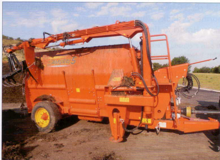
Promíchávání a homogenizace surovin – míchací a vázící stroj SEKO Sam 5-450/90 v agregaci s kolovým traktorem New Holland T7.220. Stroj s pracovním prostorem 9 m 3 má výkonnost zhruba 25 m 3 /h. Je vybaven reverzní drtičící ústrojí
